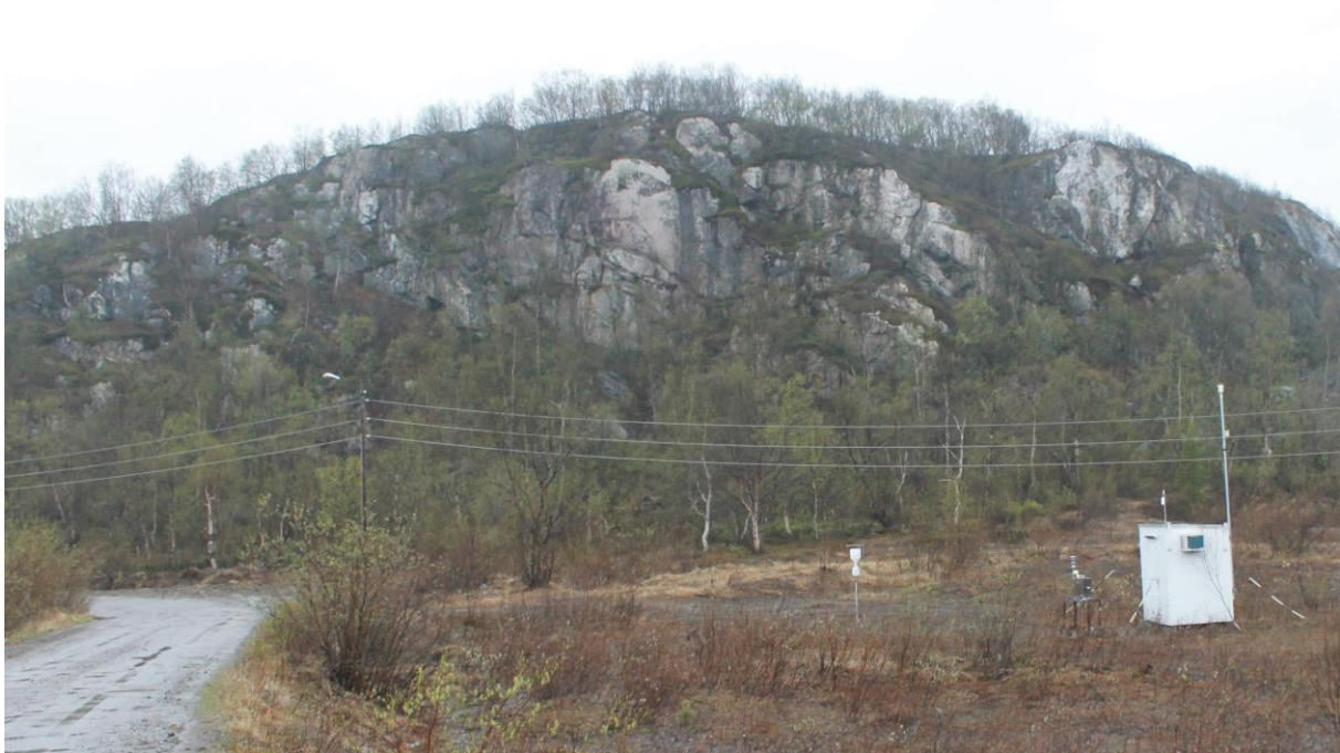
Figur 13: Målestasjonen i Karpdalen sett fra sør-øst. Stasjonen er plassert ute på et myrete jorde, samme sted som i 1986-94. Like vest for stasjonen er det en liten kolle. Måleboden har trakt og svane Hals på taket til venstre som er inntak for SO_2 , mast til høyre er meteorologiinstrumenter. Legg også merke til barduneringen, det er værhardt i Karpdalen om vinteren. Til venstre for måleboden står prøvetaker for tungmetaller i luft. Den hvite nedbørsamleren for tungmetaller i nedbør er plassert midt mellom måleboden og veien. Merk også nærhet til vei og strøm, infrastruktur er viktig kriterium for valg av plassering av målestasjon.
