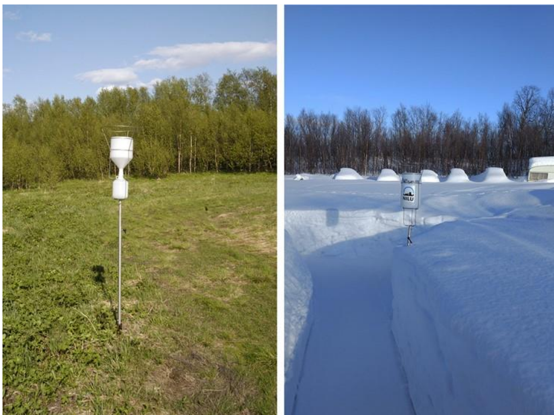
Bilde 10: Stasjonen i Karpbukt, nedbørsamleren som brukes om sommeren (venstre) og snøsamleren som brukes om vinteren. Plasttrakt fanger sommernedbøren som samles i en plastflaske. Om vinteren samles snø i prøvetaker som så må smeltes og fylles på flasker før forsendelse. Legg også merke til ringen øverst. Den er plassert slik for at fugler skal sette seg på ringen framfor kanten av samleren. Dette for å unngå fugleskit i prøven. Høyre foto: Leif Magnus Eriksen.
