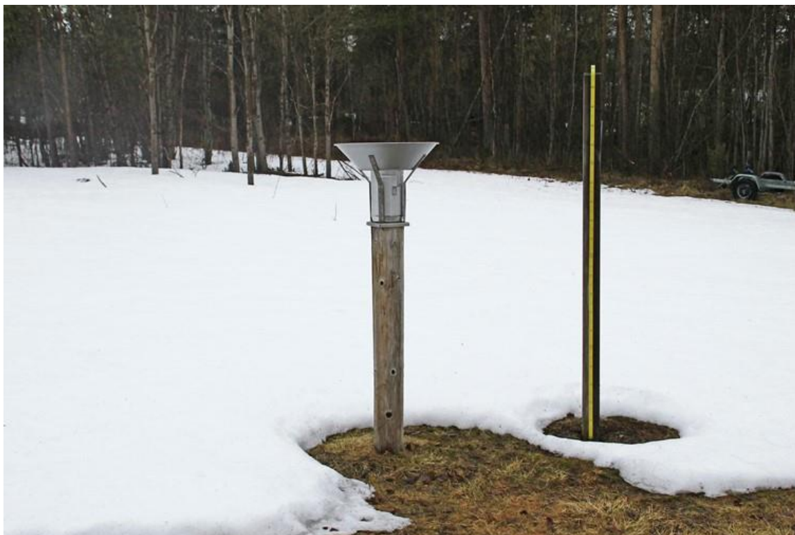
Bilde 8: Pasvik kraft sin målestasjon på Skogfoss. Stasjonen måler nedbør og snødybde på døgnbasis og data er tilgjengelige fra databasen eKlima. Bildet er tatt 25. mai 2017. Ellers kan nevnes at det dagen etter ble målt 2 cm snø på stasjonen (ingen snø da bildet ble tatt, mørk stolpe gir litt varmere mikroklima akkurat rundt målebåndet). Fotograf: Benjamin Flatlandsmo Berglen.
