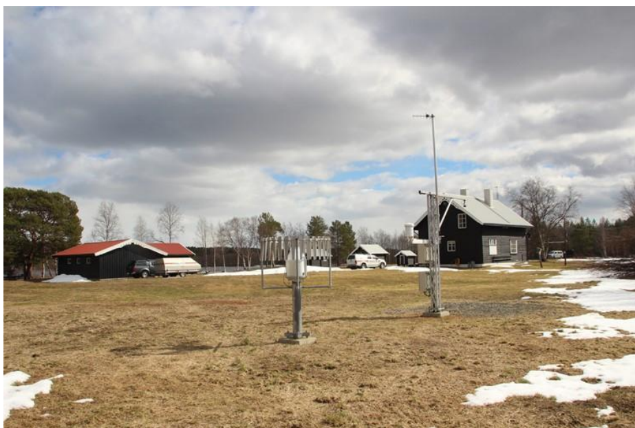
Bilde 5: Målestasjonen på Nyrud øverst i Pasvikdalen, om lag 65 km sør for Svanvik og 4 km sør for Noatun. Nedbørsamler til venstre, masten til høyre har termometer og måler for snødybde. Stasjonen driftes av Meteorologisk institutt. Bak sees Nyrud gård som nå er politistasjon, Pasvikelva skimtes bak bjørketrærne og også øya Vaarlamasari på russisk side. Bildet er tatt 27. mai 2017. Foto: Benjamin Flatlandsmo Berglen.
