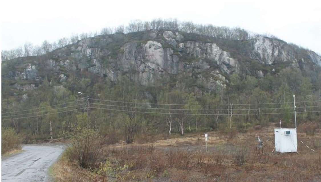
Bilde 4: Målestasjonen i Karpdalen sett fra sør-øst. Stasjonen er plassert ute på et myrete jorde, samme sted som i 1988-94. Det er ikke høytvoksende vegetasjon rundt stasjonen. Like vest for stasjonen er det en liten kolle. Måleboden har trakt og svanehals på taket til venstre som er inntak for SO_2 , mast til høyre er meteorologi-instrumenter. Legg også merke til barduneringen, det er værhardt i Karpdalen om vinteren. Til venstre for måleboden står prøvetaker for tungmetaller i luft. Den hvite nedbørsamleren for tungmetaller i nedbør er plassert midt mellom måleboden og veien. Merk også nærhet til vei og strøm, infrastruktur er viktig kriterium for valg av plassering av målestasjon.
