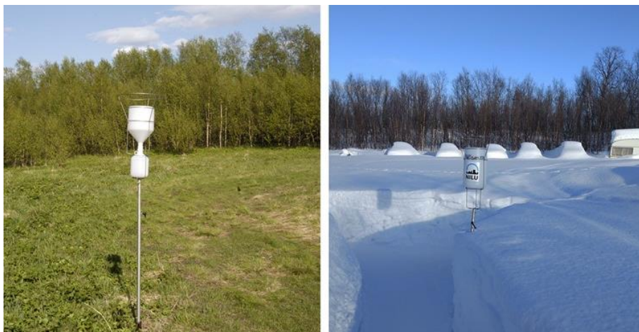
Bilde 4: Stasjonen i Karpbukt, nedbørsamleren som brukes om sommeren (venstre) og snøsamleren som brukes om vinteren. Plastrakt fanger sommernedbøren som samles i en plastflaske. Om vinteren samles snø i prøvetaker som så må smeltes og fylles på flasker før forsendelse. Legg også merkeil ringen øverst. Den er plassert slik for at fugler skal sette seg på ringen framfor kanten av samleren. Dette for å unngå fugleskit i prøven. Høyre foto: Leif Magnus Eriksen.
