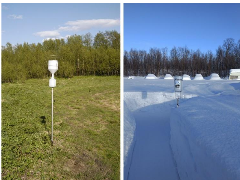
Figur 11: Stasjonen i Karpbukt, nedbørsamleren som brukes om sommeren (venstre) og snøsamleren som brukes om vinteren. Plasttrakt fanger sommernedbøren som samles i en plastflaske. Om vinteren samles snø i prøvetaker som så må smeltes og fylles på flasker før forsendelse. Legg også merke til ringen øverst. Den er plassert slik for at fugler skal sette seg på ringen framfor kanten av samleren. Dette for å unngå fugleskit i prøven. Høyre foto: Leif Magnus Eriksen.
