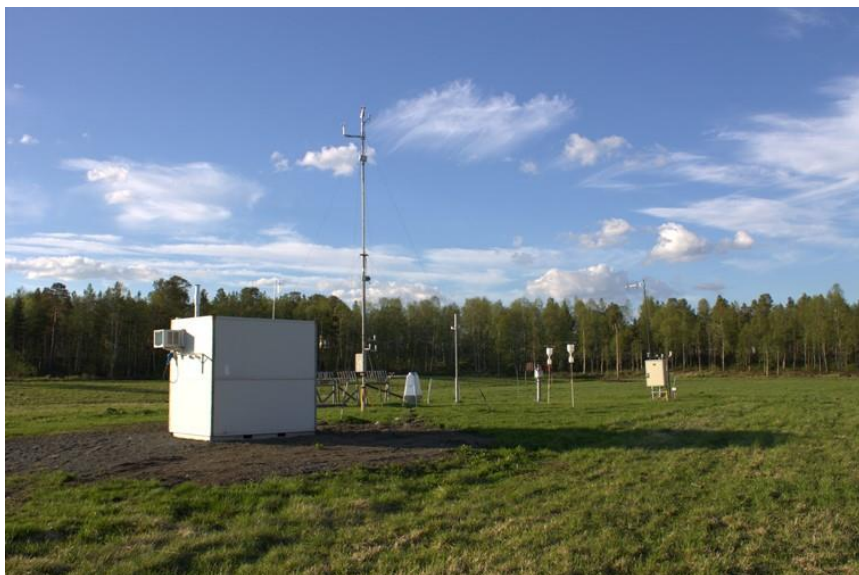
Figur 4: NILUs målestasjon på Svanvik. Den ligger ute på jordet ved Svanhovd miljøsenner (NIBIO). Merk inntak for støvmålinger på taket til venstre og inntak for SO 2 -målinger på taket til høyre (svanehal). Masten har meteorologiinstrumenter i 10 m høyde. To nedbørprøvetakere til høyre tar prøver for tungmetaller og uorganiske komponenter. Instrumentet helt til høyre tilhører NVE. Stativet med metallplater i bakgrunnen er en del av et europeisk korrosjonsprosjekt (Grøntoft og Ferm, 2014). Strålevernets instrumenter er skjult bak måleboden.
