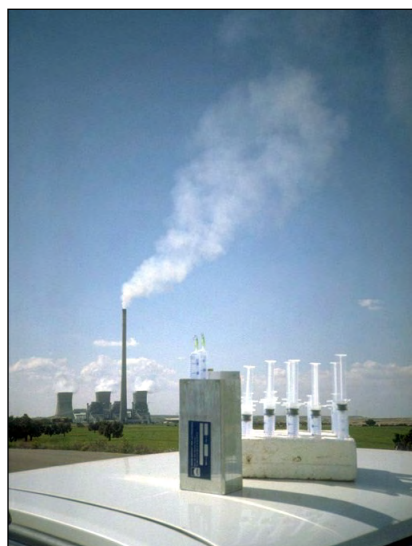
Kartlegging av spredningen fra en 343 m høy skorstein ved et kullfyrt kraftverk i Teruel, Spania, var en utfordring både for bak-kemanskap og for NILU-flyet.
