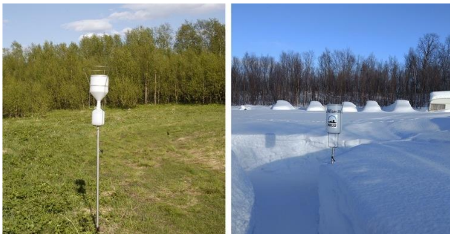
Bilde 4: Stasjonen i Karpbukt, nedbørsamleren som brukes om sommeren (venstre) og snøsamleren som brukes om vinteren. Plasttrakt fanger sommernedbøren som samles i en plastflaske. Om vinteren samles snø i prøvetaker som så må smeltes og fylles på flasker før forsendelse. Legg også merke til ringen øverst. Den er plassert slik for at fugler skal sette seg på ringen framfor kanten av samleren. Dette for å unngå fugleskit i prøven. Høyre foto: Leif Magnus Eriksen.
