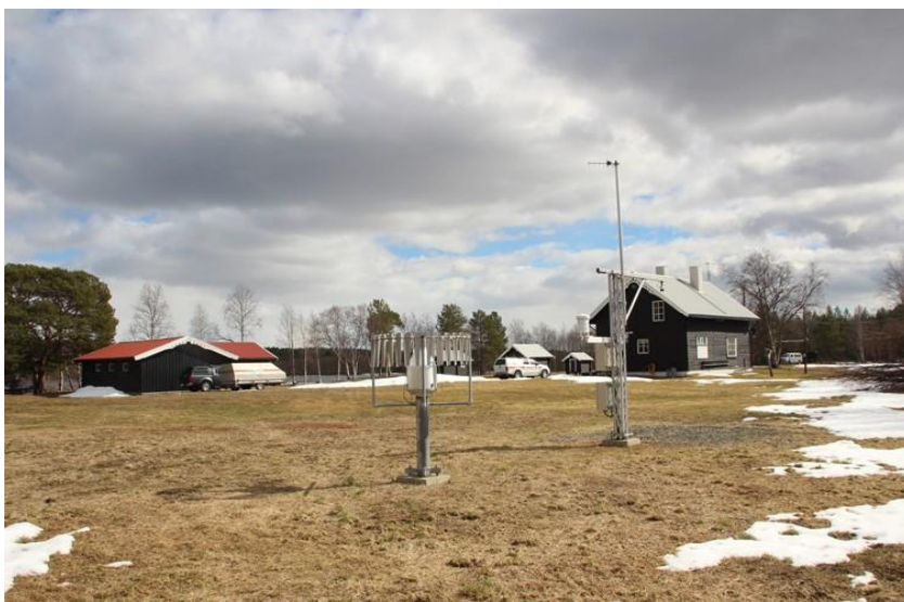
Figur 7: Målestasjonen på Nyrud øverst i Pasvikdalen, om lag 65 km sør for Svanvik og 4 km sør for Noatun. Nedbørsamler til venstre, masten til høyre har temperaturmåler og måler for snødybde. Stasjonen driftes av Meteorologisk institutt. Bak sees Nyrud gård som nå er politistasjon, Pasvikelva skimtes bak bjørketrærne og også øya Vaarlamasari på russisk side. Bildet er tatt 27. mai 2017. Foto: Benjamin Flatlandsmo Berglen.
