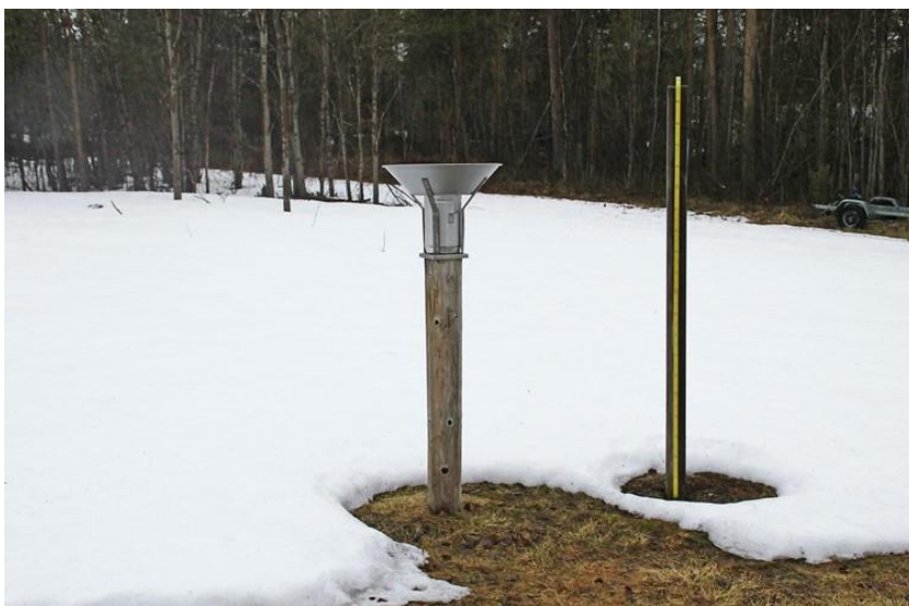
Figur 8: Pasvik kraft sin målestasjon på Skogfoss. Stasjonen måler nedbør og snødybde på døgnbasis og data er tilgjengelige fra databasen eKlima. Bildet er tatt 25. mai 2017. Ellers kan nevnes at det dagen etter ble målt 2 cm snø på stasjonen (ingen snø da bildet ble tatt, mørk stolpe gir litt varmere mikroklima akkurat rundt målebåndet). Fotograf: Benjamin Flatlandsmo Berglen.
