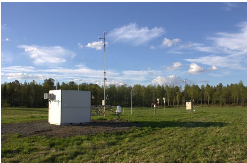
Figur 4: NILUs målestasjon på Svanvik. Den ligger ute på jordet ved Svanhovd miljøsen­ter (NIBIO). Merk inntak for støvmålinger på taket til venstre og inntak for SO 2 -målinger på taket til høyre (svane­hals). Masten har meteorologiinstrumenter i 10 m høyde. To nedbørprøvetakere til høyre tar prøver for tungmetaller og uorganiske komponenter. Instrumentet helt til høyre tilhører NVE. Stativet med metallplater i bakgrunnen er en del av et europeisk korrosjonsprosjekt (Grøntoft og Ferm, 2014). Strålevernets instrumenter er skjult bak måleboden.
