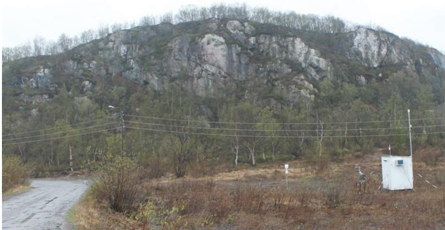
Figur 5: Målestasjonen i Karpdalen sett fra sør-øst. Stasjonen er plassert ute på et myrete jorde, samme sted som i 1988-94. Det er ikke høytvoksende vegetasjon rundt stasjonen. Like vest for stasjonen er det en liten kulle. Måleboden har trakt og svanehals på taket til venstre som er inntak for SO 2 , mast til høyre er til meteorologi-instrumenter. Legg også merke til barduneringen, det er værhardt i Karpdalen om vinteren. Til venstre for måleboden står prøvetaker for tungmetaller i luft. Den hvite nedbørsamleren for tungmetaller i nedbør er plassert midt mellom måleboden og veien. Merk også nærhet til vei og strøm, infrastruktur er viktig kriterium for valg av plassering av målestasjon.
