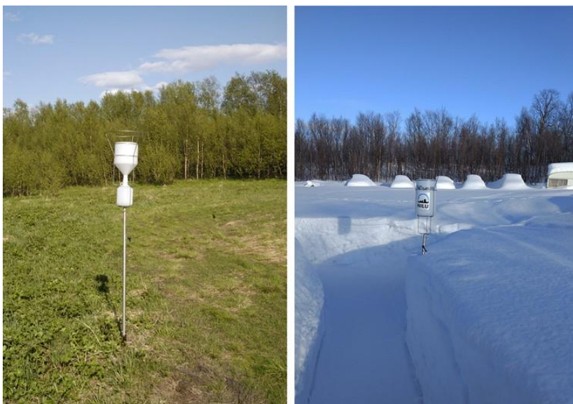
Figur 6: Stasjonen i Karpbukt, nedbørsamleren som brukes om sommeren (venstre) og snøsamleren som brukes om vinteren. Plasttrakt fanger sommernedbøren som samles i en plastflaske. Om vinteren samles snø i prøvetaker som så må smeltes og fylles på flasker før forsendelse. Legg også merke til ringen øverst. Den er plassert slik for at fugler skal sette seg på ringen framfor kanten av samleren. Dette for å unngå fugleskit i prøven. Høyre foto: Leif Magnus Eriksen.
