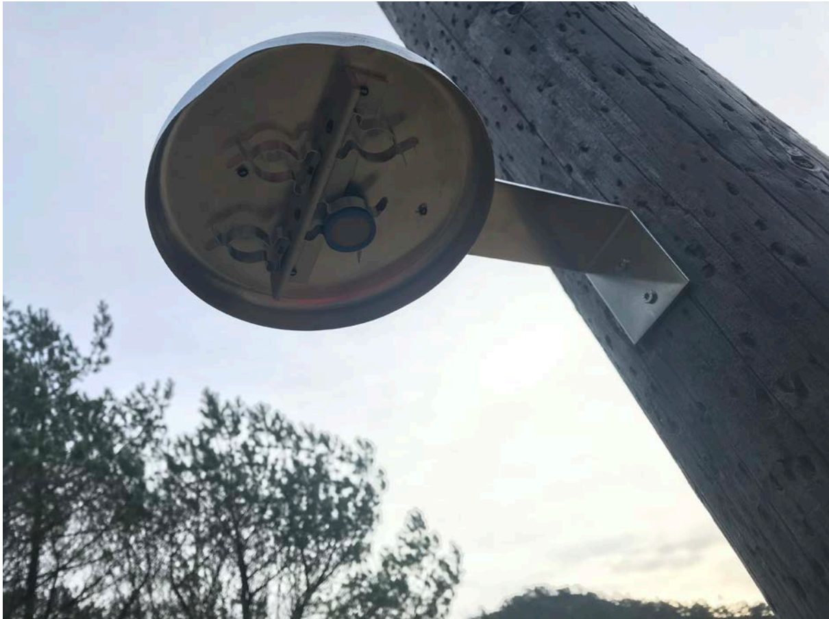
Figur 1: Passiv prøvetaker i stativ som gir værbeskyttelse.
