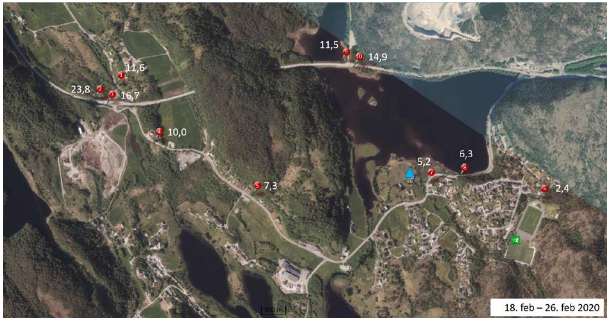
Figur 12: Geografisk fordeling av NO 2 i måleområdet i fjerde eksponeringsperiode (18. feb. – 26. feb. 2020). Konsentrasjonene er angitt i µg/m 3 .
