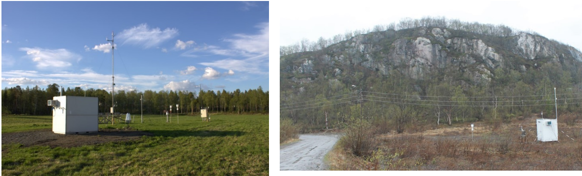
Bilde 2: NILUs målestasjoner. Svanvik (venstre) ligger ute på jordet ved NIBIO Svanhovd. Merk inntak for støvmålinger på taket til venstre og inntak for SO 2 -målinger på taket til høyre (svanehals). Masten har meteorologi-instrumenter i 10 m høyde. To nedbørprøvetakere til høyre tar prøver for tungmetaller. Instrumentet helt til høyre tilhører NVE. Stativet med metallplater i bakgrunnen er en del av et europeisk korrosjonsprosjekt (Grøntoft, 2016). Strålevernets instrumenter er skjult bak måleboden. Karpdalen (høyre) der måleboden har trakt og svanehals på taket til venstre som er inntak for SO 2 , mast til høyre er for meteorologi-instrumenter. Til venstre for måleboden står svevestøvprøvetaker for tungmetaller i luft. Den hvite nedbørsamleren for tungmetaller i nedbør er plassert midt mellom måleboden og veien.
