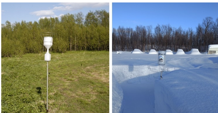
Bilde 4: Stasjonen i Karpbukt, nedbørsamleren som brukes om sommeren (venstre) og snøsamleren som brukes om vinteren. Plasttrakten fanger sommernedbøren i en plastflaske. Om vinteren samles snø i prøvetakeren som så må smeltes og fylles på flasker før forsendelse. Ringen øverst sørger for at fugler setter seg på ringen framfor på kanten av samleren. Dette for å unngå fugleskit i prøven. Høyre foto: Leif Magnus Eriksen.
