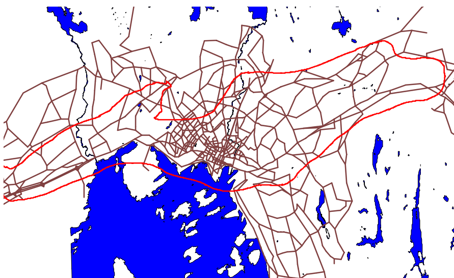
Figur 12: Risiko-områdene for kobber i Oslo med grense mellom risikoklasse 2 og 3 målt som levetid. Risikoklasse 3 med korteste levetid er i utkanten av Oslo.
