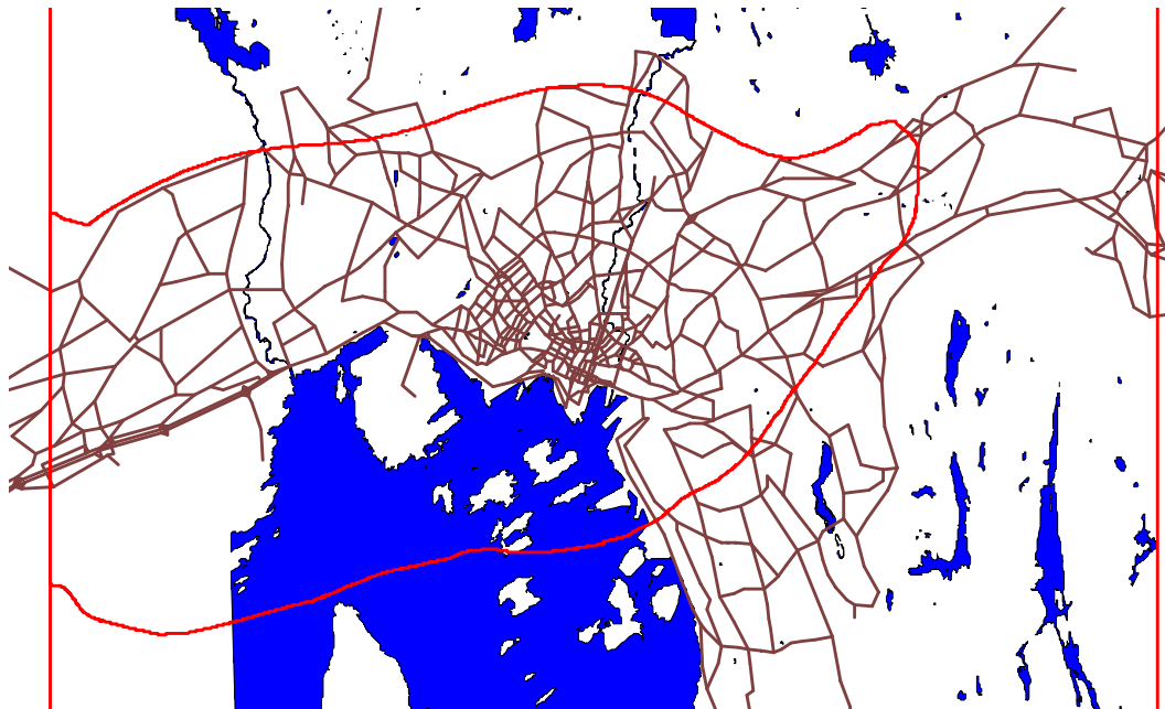
Figur 14: Risiko-områdene for malte materialer, puss og takpapp i Oslo med grense mellom risikoklasse 2 og 3 målt som levetid. Risikoklasse 3 med korteste levetid er i sentrum.
