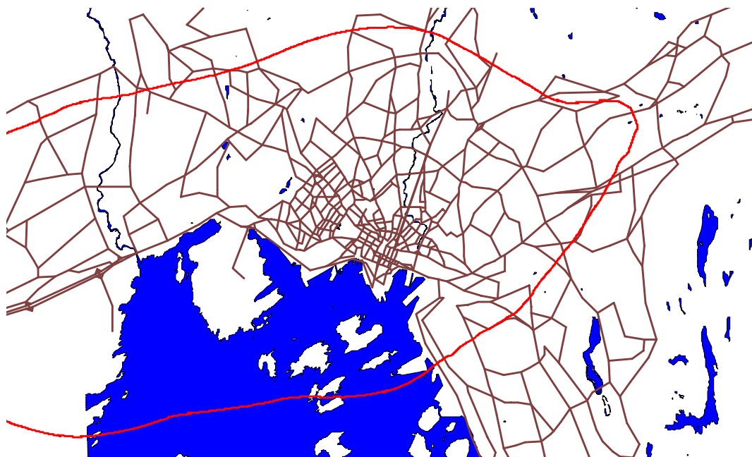
Figur 9: Risiko-områdene for bronse og aluminium i Oslo med grense mellom risikoklasse 2 og 3. Risikoklasse 3 med høyeste korrosjonshastighet er i sentrum.
