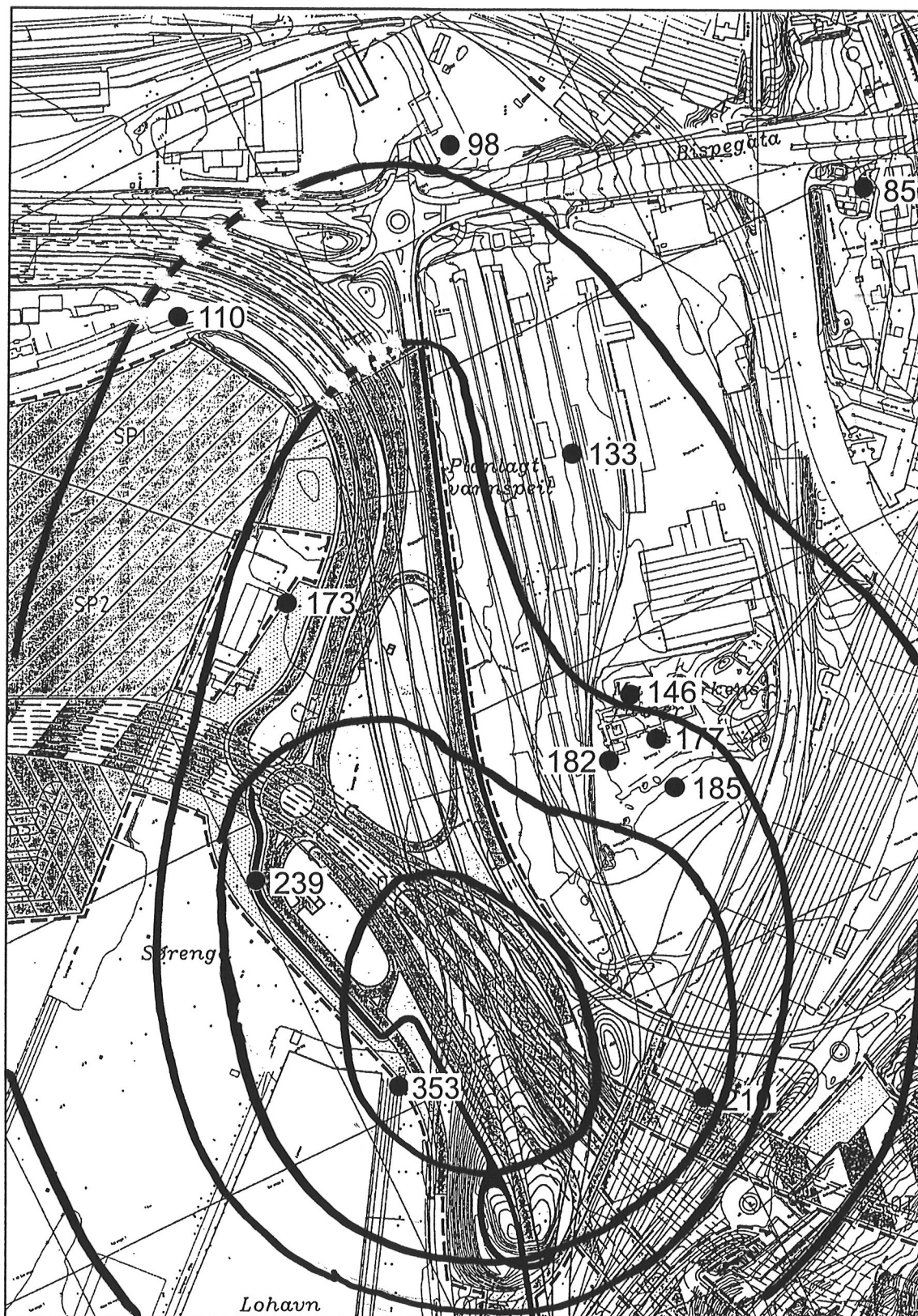
Figur 4: Omhyldningskurver for NO 2 -konsentrasjon uavhengig av vindretning. Enhet µg/m 3 . Linjene viser 300 µg/m 3 , 200 µg/m 3 , 150 µg/m 3 og 100 µg/m 3 .
