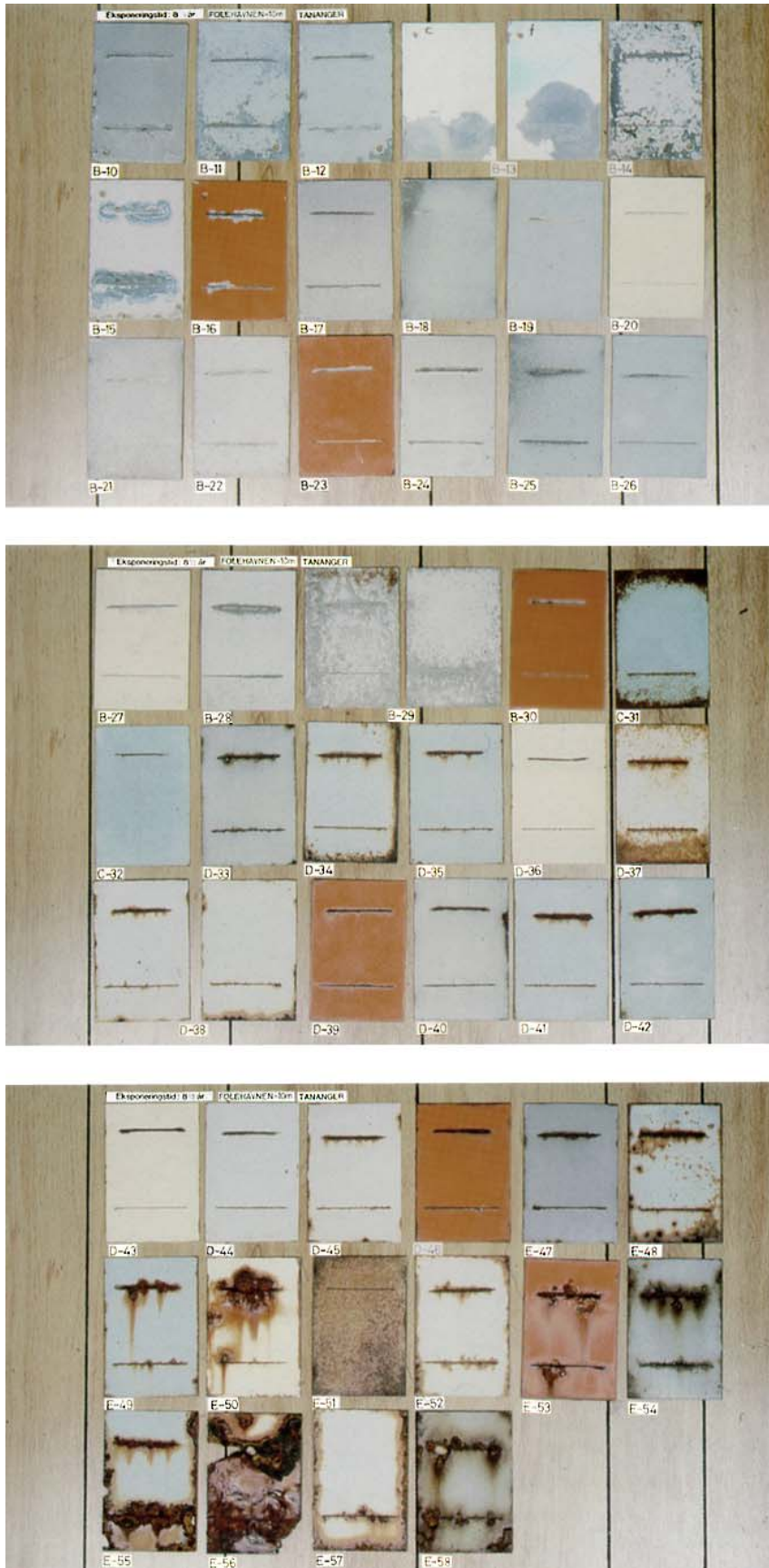
Figur 9: Alle systemene med maling etter 8,5 års eksponering på Tananger.
