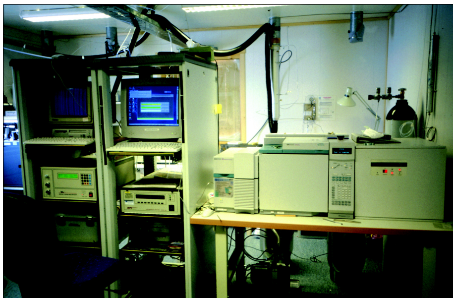
ADS-GC-MS, instrument for måling av lettflyktige halogenererte forbindelser.
