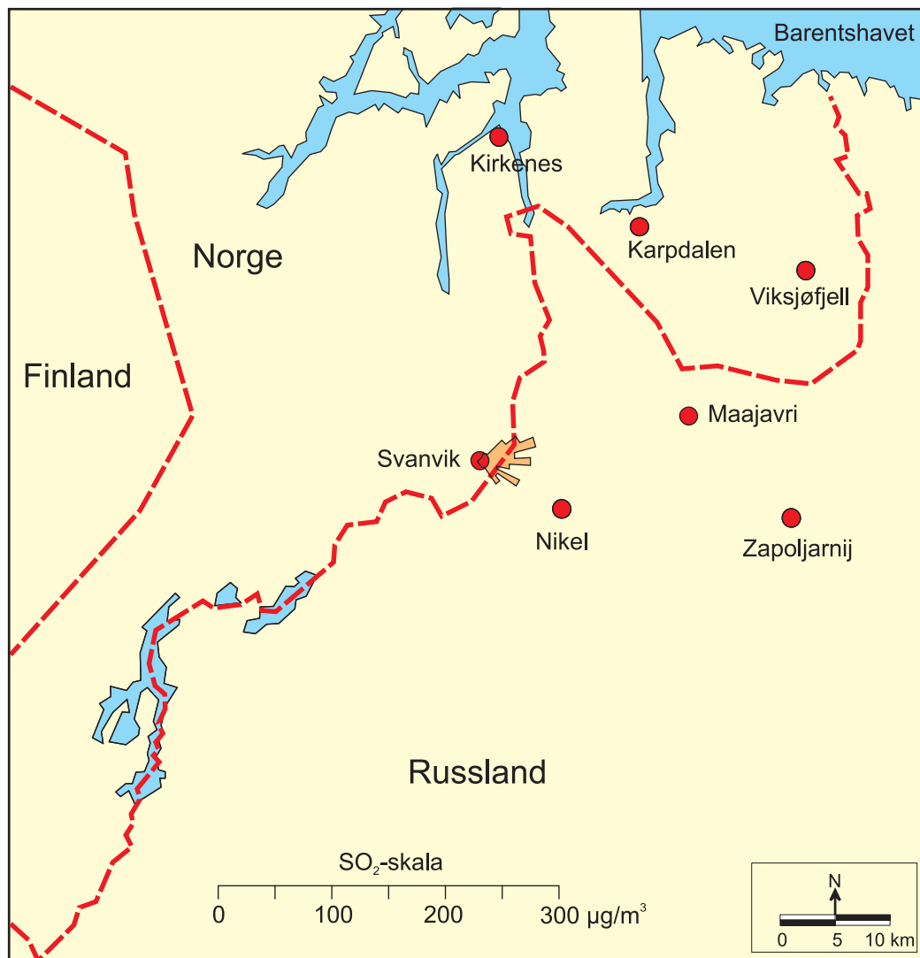
Figur 3: Middelkonsentrasjoner av \text{SO}_2 i Svanvik og Nikel i perioden april-september 2003 ( \mu\text{g}/\text{m}^3 ). Figuren viser middelkonsentrasjoner av \text{SO}_2 for hver av 36 10^\circ -vindsektorer. Svanvik er belastet fra Nikel og Zapoljarnij (mest fra Nikel).
