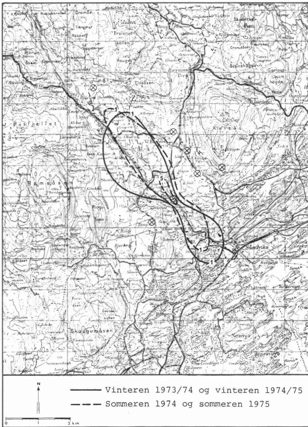
Figur 15: Midlere bakkekonsentrasjoner som følge av et utslipp av støv og HCl på 10 kg/time fra en 10 m høy skorstein ved Løxa basert på målte meteorologiske spredningsforhold ( \mu\text{g}/\text{m}^3 ).
