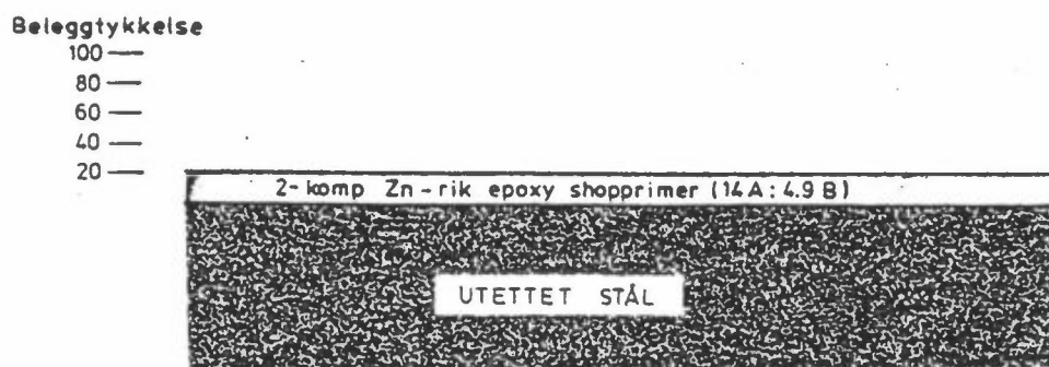
Figur 21: System: Zn - rik epoxy shopprimer + overmalingsystemene fra metalliserte belegg.
