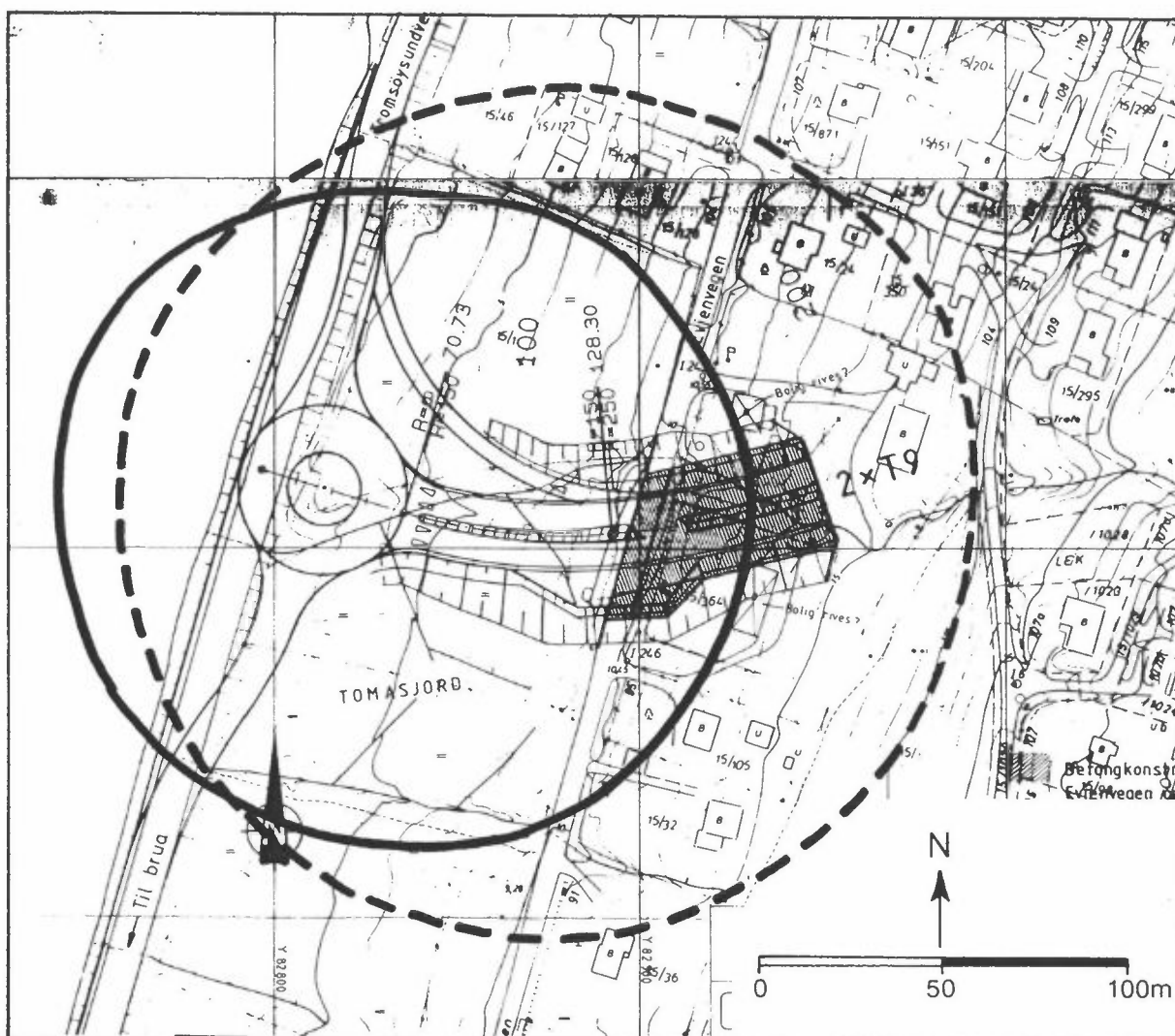
Figur 3: Munning ved Tomasjord, ettermiddagstrafikk. Områder hvor overskridelse av grenseverdi for \text{NO}_2 kan forekomme er markert. Stiplet linje viser områder ved ventilasjonshastighet lik 2,9 m/s, heltrukken linje viser for 5 m/s.
