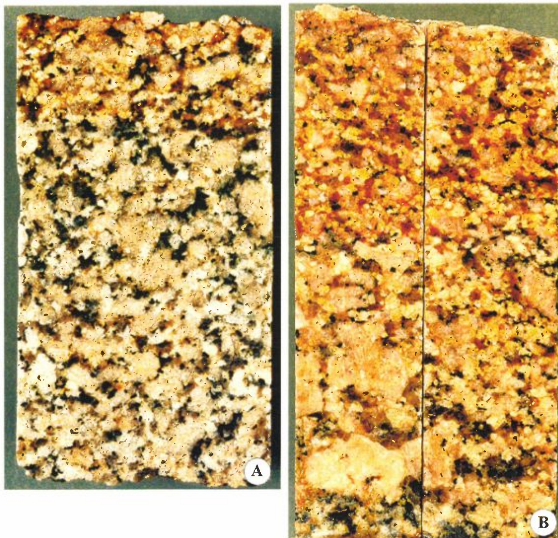
Figur 52: Tverrsnitt av borekjerne fra hver side av innsamlingsfelt for avrenningsvann som illustrerer ulike fargenyanser i bergarten. A). Borekjerne fra nordsiden av feltet (III/1). Øverst er en ca. 2 cm tykk gulbrun - rødlig forvittringssone. Under denne har bergarten en grålig til svak rosa farge. Denne delen representerer tilsynelatende frisk, uforvitret bergart. B). Borekjerne fra sørsiden av avrenningsfelt (II/3). Hele kjernen har en gulbrun farge. Øverste ca. 3.5 cm har imidlertid en mere rødlig farge og representerer trolig forvittringssonen.
