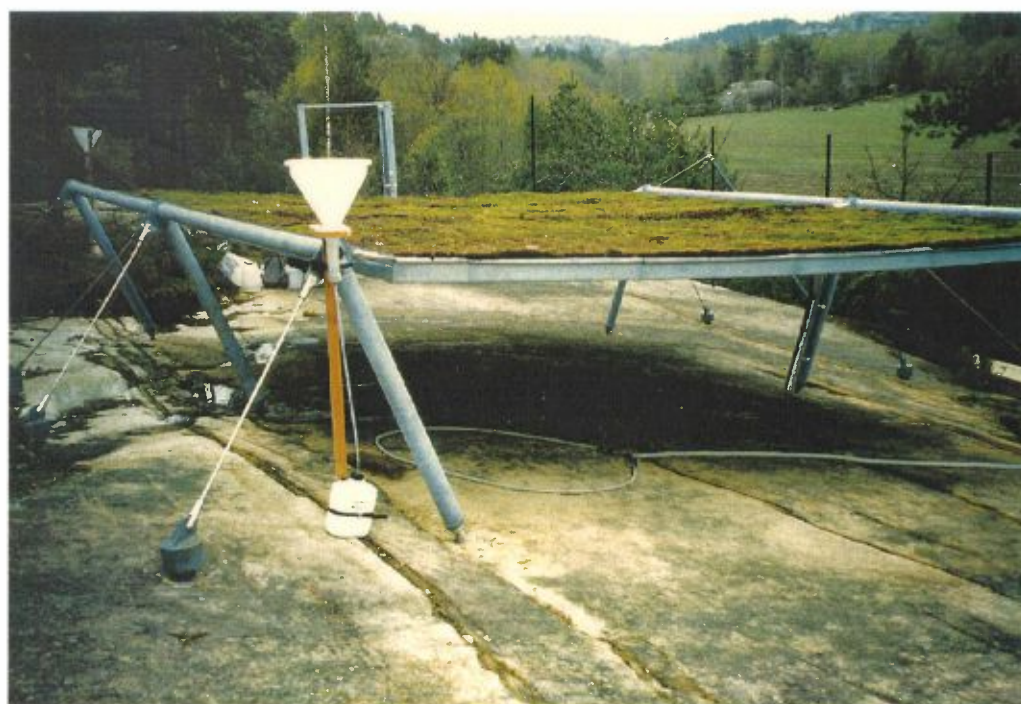
Figur 6: Prøvefeltet på Litsleby, sett mot S. Bildet viser takkonstruksjonen med området for innsamlingen av avrenning under taket.
