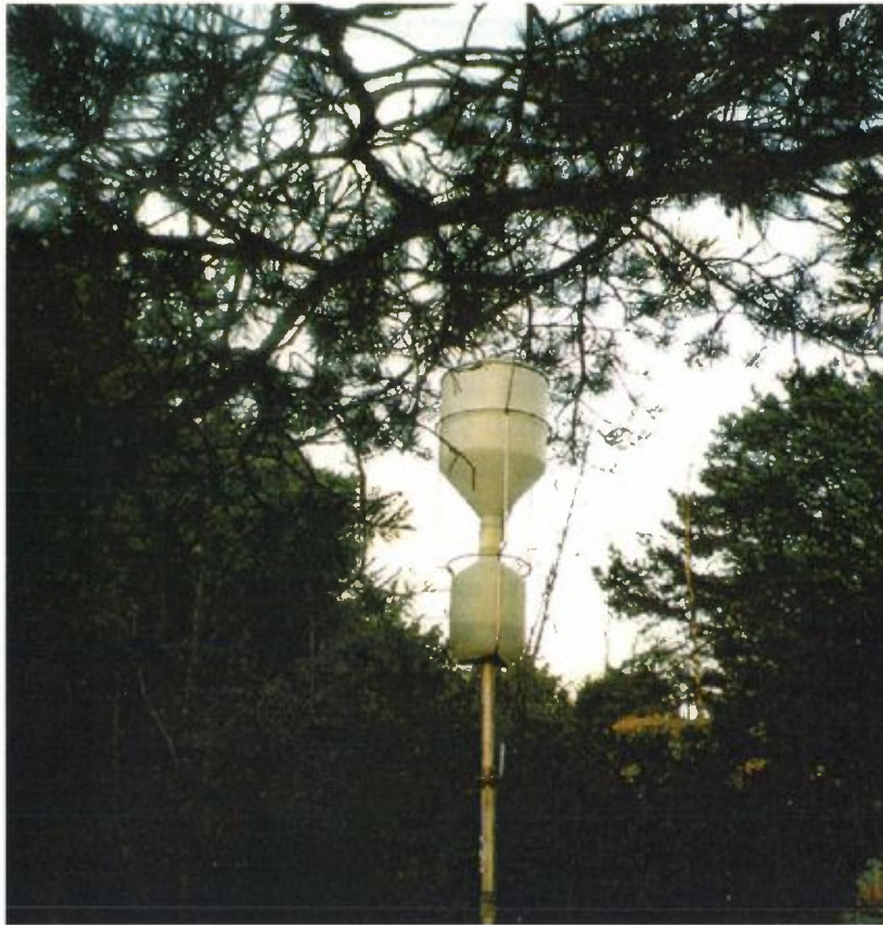
Figur 8: NILUs nedbørsamler montert under et furutre, 12,5 m nord for nedbørsamleren.
