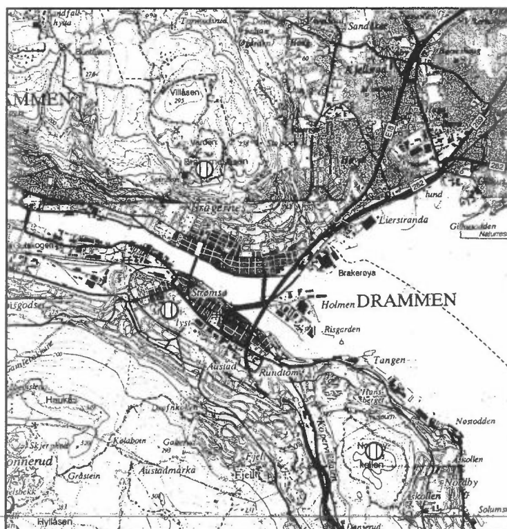
Figur 1: Lokalisering av planlagt utluftingssjakt for avgasser fra Bragernes-tunnelen på Spiraltoppen i Drammen, samt lokalisering av meteorologiske målestasjoner (vindstyrke, vindretning, temperatur og stabilitet).
