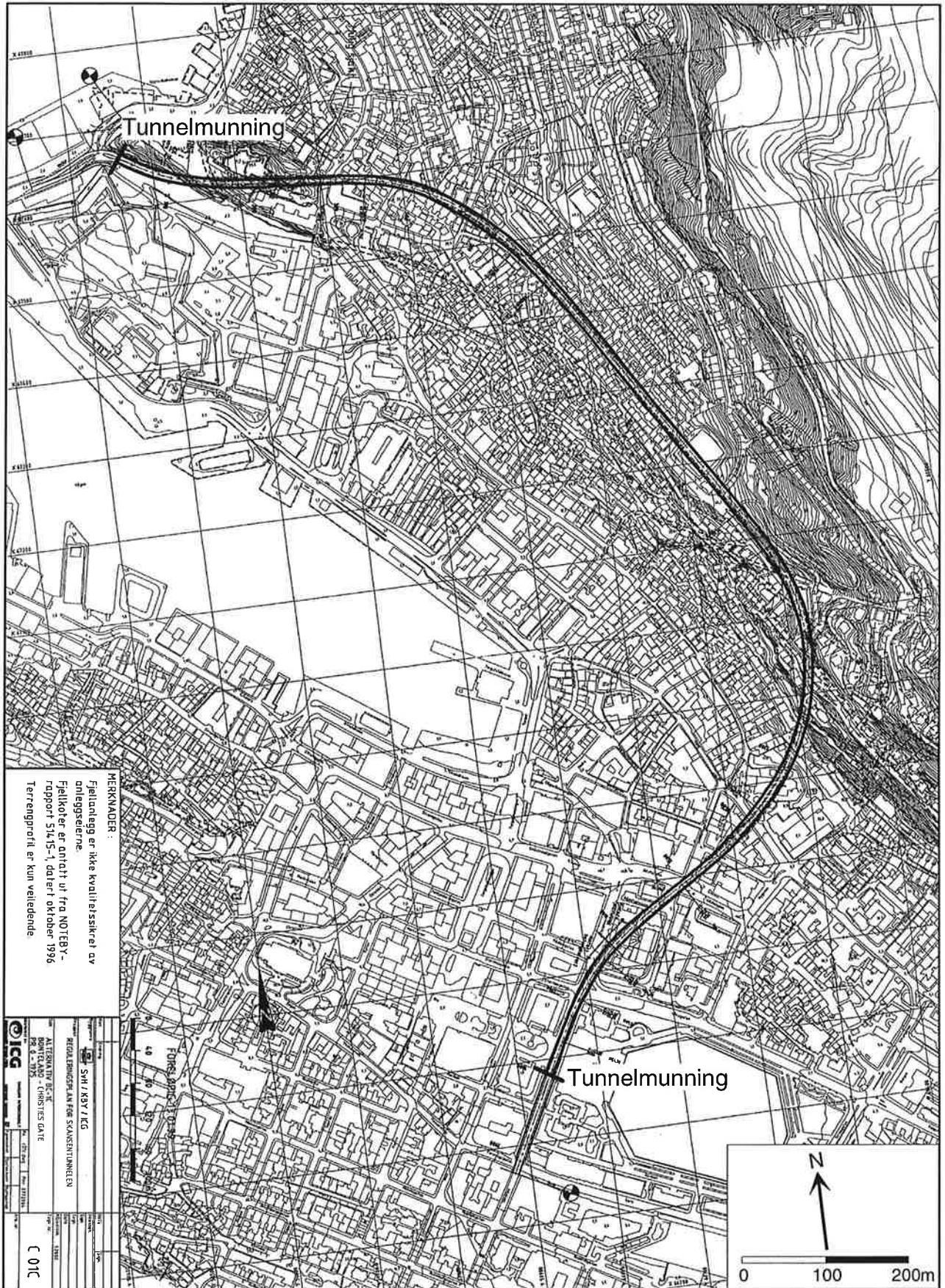
Figur 1: Tunneltrasé, Skansentunnelen. Alternativ Christies gt.-Bontelabo.
