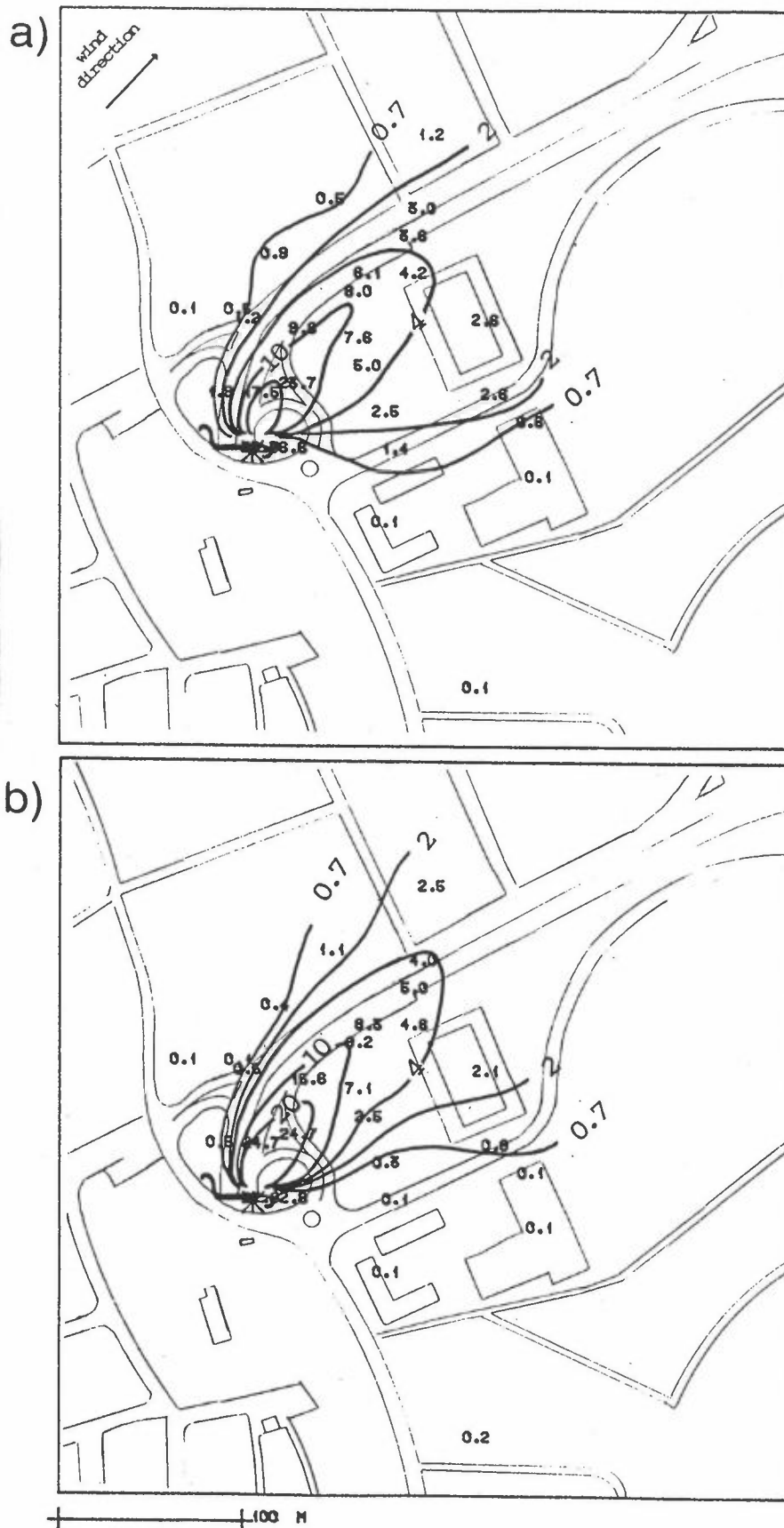
Figur 9: Isolinjer for normalisert SF 6 -konsentrasjon ( \mu\text{g m}^{-3} / \text{g min}^{-1} ) i test 2A (øverst) og 2B (nederst).
