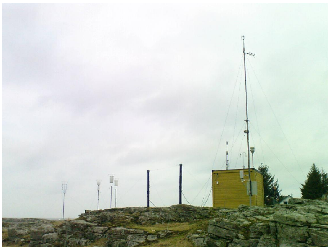
Figur 3: Målestasjonen på Herdlevær med målebu, meteorologimast, støv- og nedbørsamlere.
