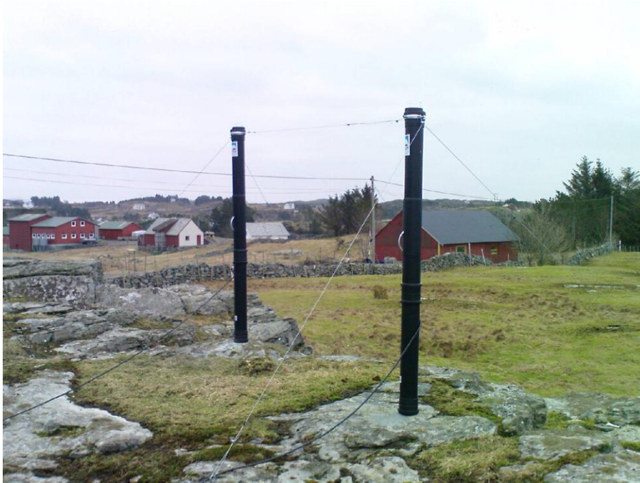
Figur 13: Prøvetakere for Hg i nedbør på Herdlevær. Selve prøvetakeren i glass og oppvarmingsenheten er pakket inn i plastrør.
