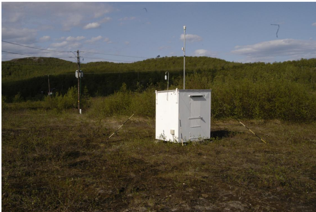
Figur 7: Målestasjonen i Karpdalen. Stasjonen er plassert ute på et myrete jorde, samme sted som i 1986-94. Trakt og svanehals på taket til venstre er inntak for SO 2 , mast midt på er meteorologiinstrumenter. Legg også merke til barduneringen, det er værhardt i Karpdalen om vinteren.
