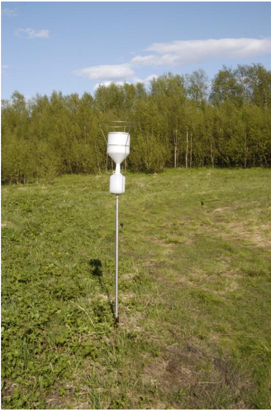
Figur 23: Nedbørsamleren i Karpbukt. Plasttrakt fanger nedbøren som samles i en plastflaske. Legg også merke til ringen øverst. Den er plassert slik for at fugler skal sette seg på ringen framfor kanten av samleren. Dette for å unngå fugleskit i prøven.
