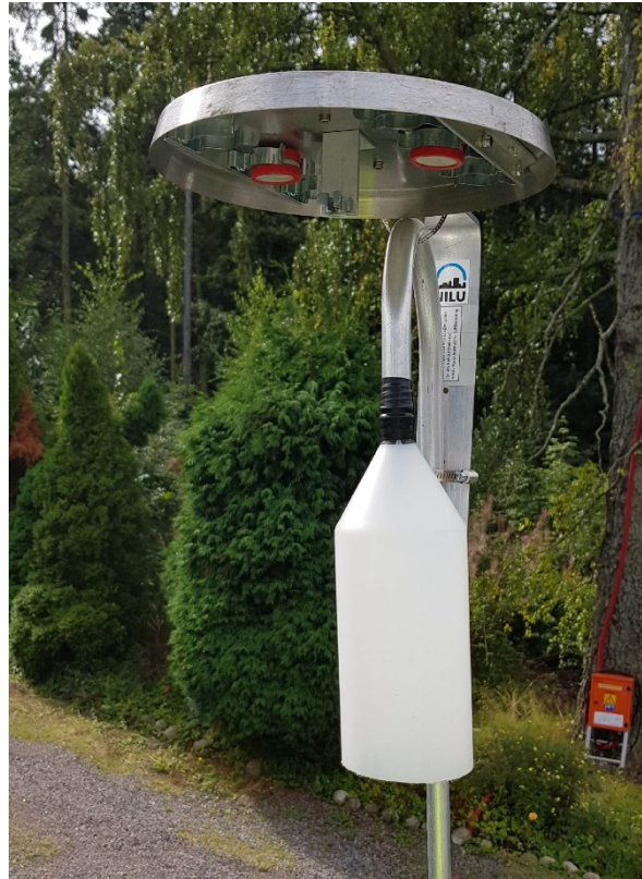
Figur 5: Passive prøvetakere i stativ som gir værbeskyttelse. Her vises prøvetakeren som er kolokalisert med målestasjonen i Konsul Wilds Vei. Merk at den er montert rett ovenfor inntaket til SO 2 -monitoren. I september, oktober og november 2019 ble det målt med to parallelle passive prøvetakere ved måleboden. Foto: Even Kristian Teigland.
