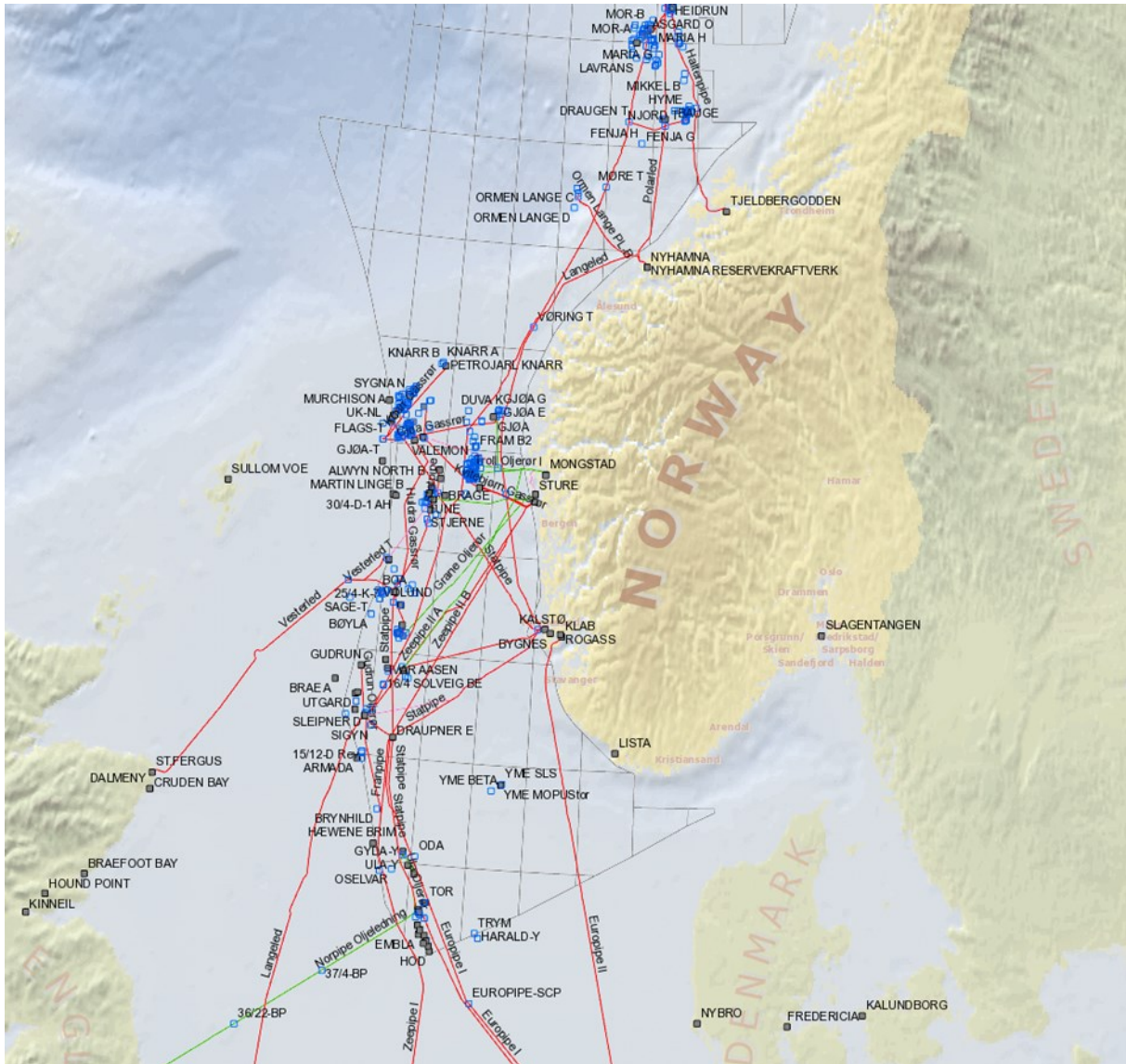
Figur 21: Kart over olje og gass installasjoner på norsk sokkel og norske landbaserte anlegg. Blå firkanter viser undervannsinstallasjoner, sorte firkanter overflateinstallasjoner, grønne linjer viser oljerørledninger, og røde linjer gassrørledninger. Hentet fra https://factmaps.npd.no/factmaps/3_0/ .
