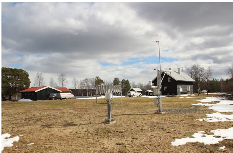
Figur 9: Målestasjonen ved Nyrud øverst i Pasvikdalen, om lag 65 km sør for Svanvik og 4 km sør for Noatun. Nedbørsamler til venstre, masten til høyre har termometer og måler for snødybde. Stasjonen driftes av Meteorologisk institutt. Bak sees Nyrud gård som nå er politistasjon, Pasvikelva skimtes bak bjørketrærne og også øya Vaarlamasari på russisk side. Bildet er tatt 27. mai 2017. Foto: Benjamin Flatlandsmo Berglen.
