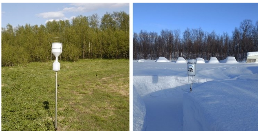
Bilde 4: Stasjonen i Karpbukt, nedbørsamleren som brukes om sommeren (venstre) og snøsamleren som brukes om vinteren. Plasttrakten fanger sommernedbøren i en plastflaske. Om vinteren samles snø i prøvetakeren som så må smeltes og fylles på flasker før forsendelse. Ringen øverst sørger for at fugler setter seg på ringen framfor på kanten av samlere. Dette for å unngå fugleskit i prøven. Høyre foto: Leif Magnus Eriksen.
