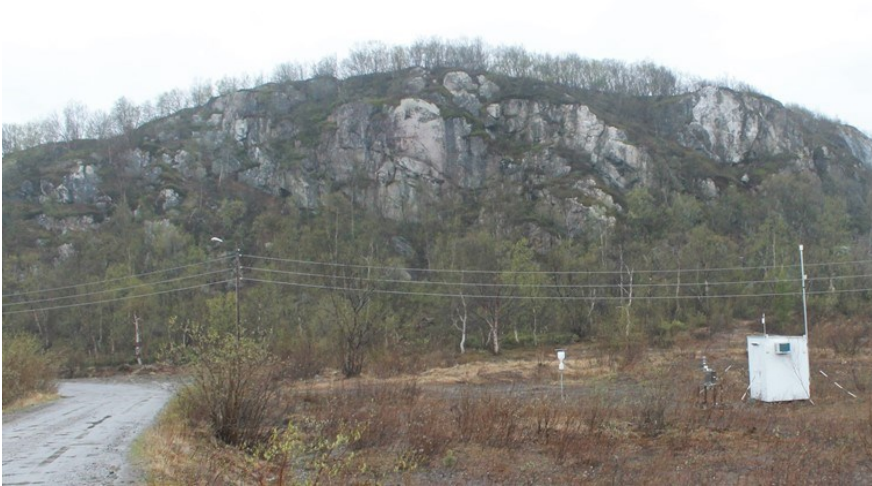
Figur 8: Målestasjonen i Karpdalen sett fra sør-øst. Stasjonen er plassert ute på et myrete jorde, samme sted som i 1988-94. Det er ikke høytvoksende vegetasjon rundt stasjonen. Like vest for stasjonen er det en liten kolle. Måleboden har trakt og svanehals på taket til venstre som er inntak for SO 2 , mast til høyre er til meteorologi-instrumenter. Legg også merke til barduneringen, det er værhardt i Karpdalen om vinteren. Til venstre for måleboden står prøvetaker for tungmetaller i luft. Den hvite nedbørsamleren for tungmetaller i nedbør er plassert midt mellom måleboden og veien. Merk også nærhet til vei og strøm, infrastruktur er viktig kriterium for valg av plassering av målestasjon.
