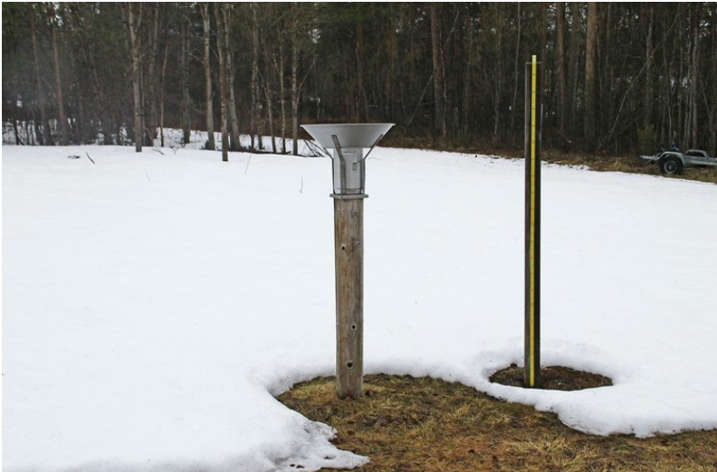
Figur 10: Pasvik kraft sin målestasjon på Skogfoss. Stasjonen måler nedbør og snødybde på døgnbasis og data er tilgjengelige fra databasen seKlima. Bildet er tatt 25. mai 2017. Ellers kan nevnes at det dagen etter ble målt 2 cm snø på stasjonen (ingen snø da bildet ble tatt, mørk stolpe gir litt varmere mikroklima akkurat rundt målebåndet). Foto: Benjamin Flatlandsmo Berglen.
