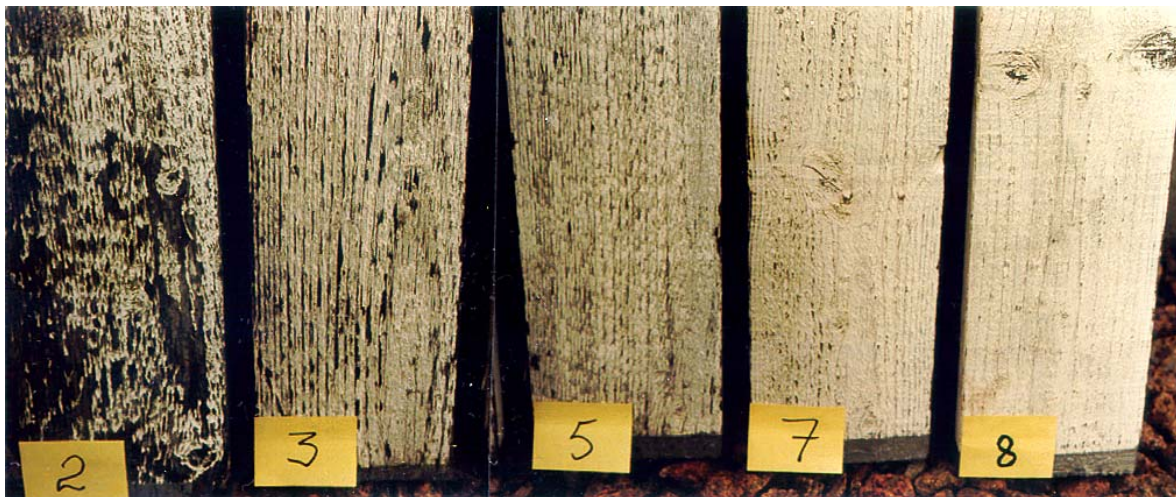
Figur 18: NILU-standard for evaluering av mengde avflaking gradert mellom 1 og 10. Panelene som er av uhøvlet gran er 10 cm brede og malt med hvit alkyd maling. (Foto Odd Anda).
