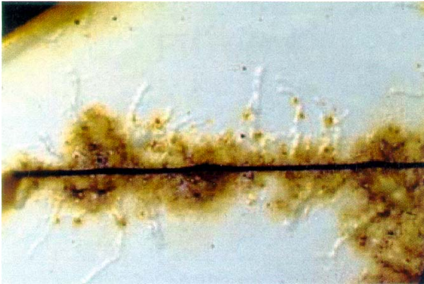
Figur 14: Filiformkorrosjon (leksikalt referansefoto). Det vannrette risset er 1 mm bredt. (Foto Odd Anda).
