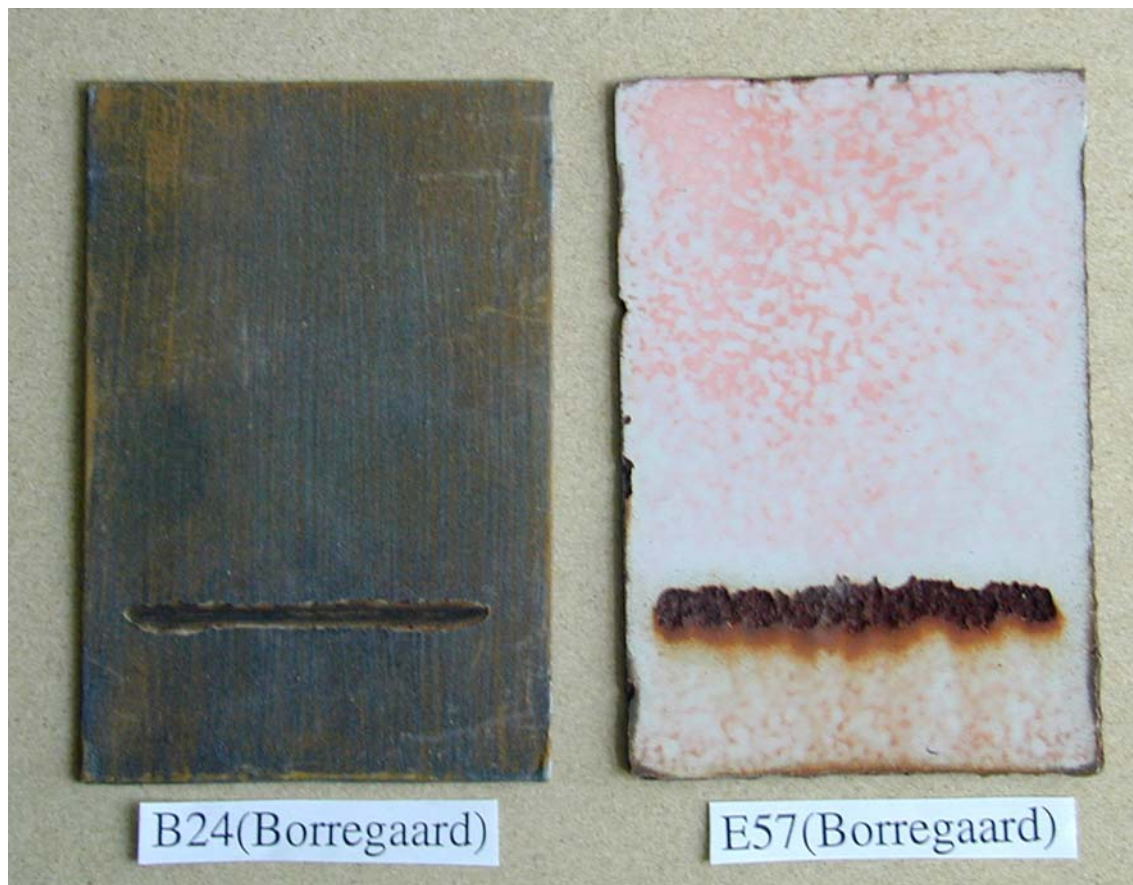
Figur 13: Eksempler på slitasje eller erosjon. Dette skyldes dels vær og vind og dels kjemisk forvitring. Det øverste malingsjiktet er i større eller mindre grad slitt bort. Underlagssjiktet blir lettere synlig om det har en annen farge enn den eroderte toppfilmen. Prøvene som er fra Sarpsborg (Borregaard) har vært eksponert i ca. 24 år. Prøveplatene er 10x15 cm. (Foto Odd Anda).
