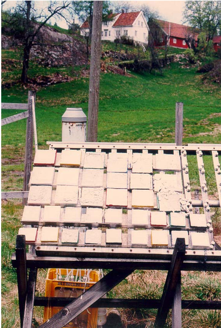
Figur 20: Feltprøving av puss med oppsamling av regnvann fra prøvene (Birkenes). (Foto Odd Anda).
