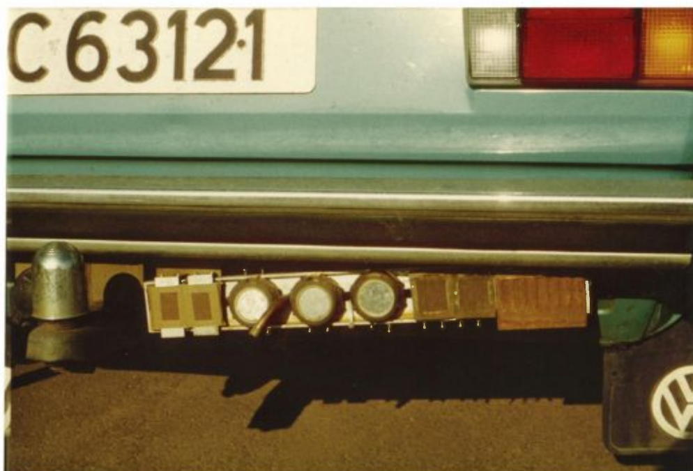
Figur 1: Prøveoppsettet under bakre støtfanger. Fra venstre er plasseringen 2 vekttafsplater, 3 avleiringsholdere, 2 pakkeceller og 1 platecelle. Inntaket for gassinnsamlingen sitter midt på stativet.
