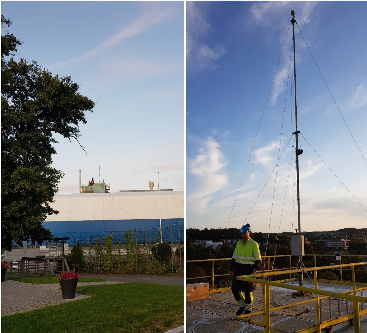
Figur 4: Meteorologisk mast på taket av bygget som huser koksovnene, rett ved falkene fra kalsineringsovnene. Masten er midt i venstre bilde. Foto: Even Kristian Teigland.
