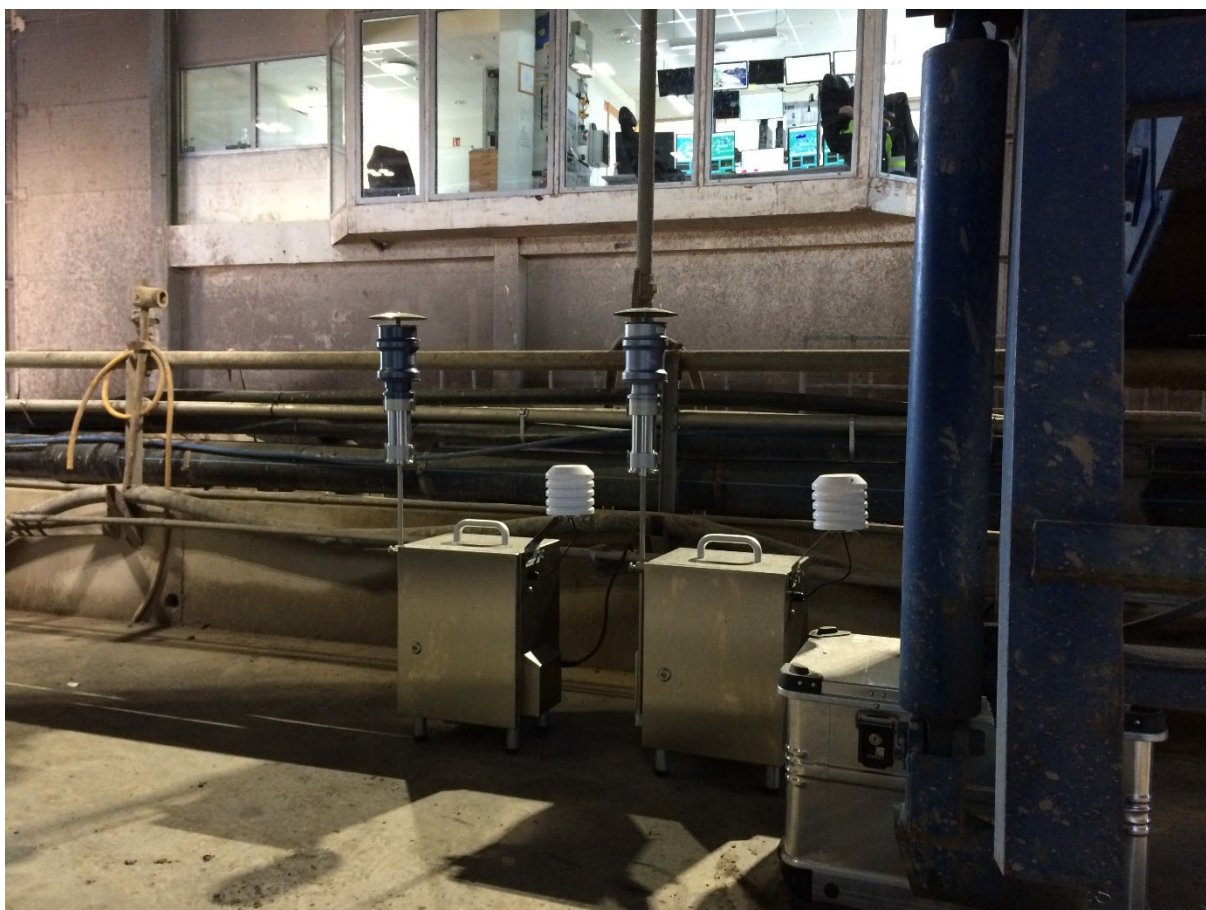
Figur 5: Aktiv prøvetaking ved lokasjon (5) ved Eide Sotra. For å spare tid ble det benyttet to parallelle prøvetakere ved hvert prøvetakingssted. Luft suges inn gjennom en åpning under hatten (mørkegrå enhet), deretter gjennom en impaktorplate der de største partiklene sorteres ut, og så gjennom et filter/XAD2 der miljøgiftene avsettes/adsorberes. Inne i den grå boksen er det pumpe og diverse elektronikk, blant annet logger. Merk at prøvetakeren er forholdsvis tung og uhåndterlig og krever strøm, dette gir visse begrensninger med tanke på plassering. Se Vedlegg A for bilder av de andre lokasjonene.
