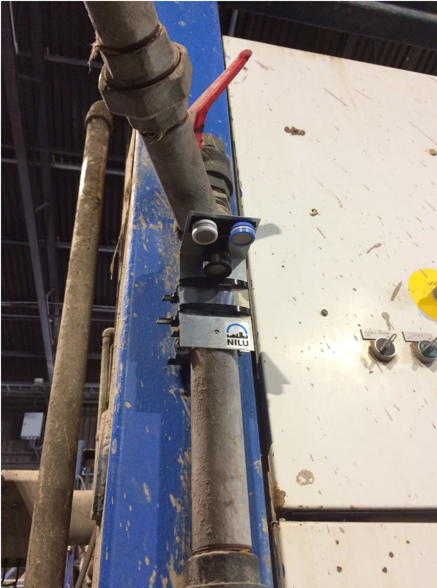
Figur 6: Passiv prøvetaking ved lokasjon (5) ved Eide Sotra. Prøvetakerne består av et impregnert filter som plasseres i en holder som monteres med åpningen ned. Det er også tak over prøvetakerne for å beskytte mot nedbør, dog er dette egentlig ikke nødvendig ved prøvetaking innendørs. Hvit prøvetaker til venstre er \text{NH}_3 , blå til høyre er \text{HCl} , mens sort prøvetaker bak er \text{H}_2\text{S} . Merk at prøvetakerne er små og lette og de krever ikke strøm. Dette gir fleksibilitet med tanke på plassering.
