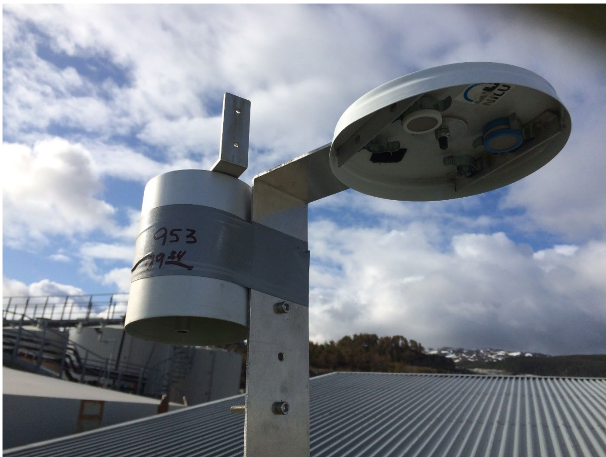
Figur 8: Passiv prøvetaking ved lokasjon (3) ved Husøya Kristiansund. I holderen til venstre kan det skimtes tenax-rør for prøvetaking av flyktige organiske forbindelser. Under «steikepanna» til høyre vises hvit prøvetakere for NH 3 og blå for HCl. Det ble ikke tatt prøver av H 2 S ved Husøya. Se Vedlegg A for bilder av de andre lokasjonene.
