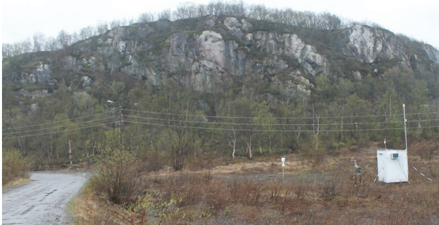
Figur 9: Målestasjonen i Karpdalen sett fra sør-øst. Stasjonen var plassert ute på et myrete jorde, samme sted som i 1988-94. Det er ikke høytvoksende vegetasjon rundt stasjonen. Like vest for stasjonen er det en liten kolle. Måleboden har trakt og svanehal på taket til venstre som er inntak for SO 2 , mast til høyre er til meteorologi-instrumenter. Legg også merke til barduneringen, det er værhardt i Karpdalen om vinteren. Til venstre for måleboden står prøvetaker for tungmetaller i luft. Den hvite nedbørsamleren for tungmetaller i nedbør er plassert midt mellom måleboden og veien. Merk også nærhet til vei og strøm, infrastruktur er viktig kriterium for valg av plassering av målestasjon.
