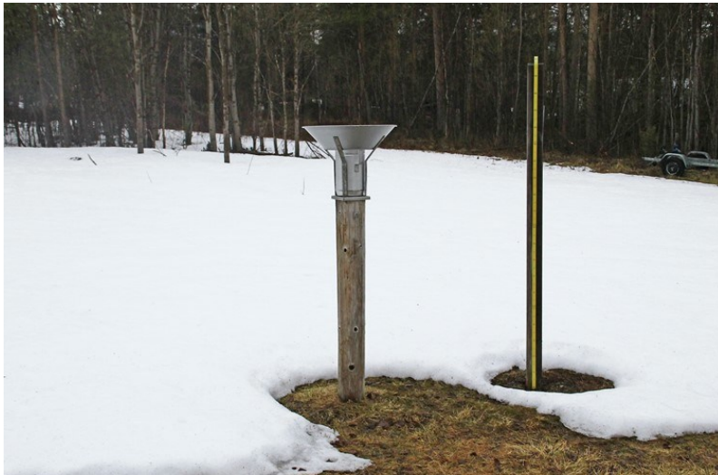
Figur 11: Pasvik kraft sin målestasjon på Skogfoss. Stasjonen måler nedbør og snødybde på døgnbasis og data er tilgjengelige fra databasen seKlima. Bildet er tatt 25. mai 2017. Ellers kan nevnes at det dagen etter ble målt 2 cm snø på stasjonen (ingen snø da bildet ble tatt, mørk stolpe gir litt varmere mikroklima akkurat rundt målebåndet). Foto: Benjamin Flatlandsmo Berglen.
