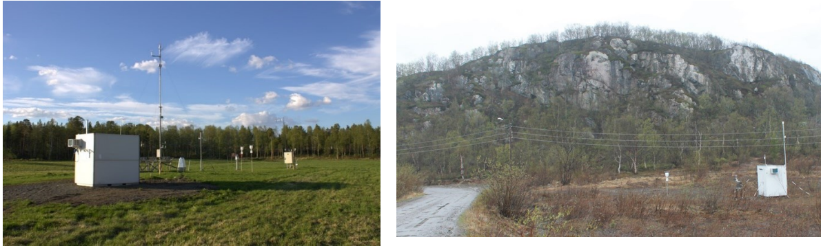
Bilde 3: NILUs målestasjoner i 2021. Svanvik (venstre) ligger ute på jordet ved NIBIO Svanhovd. Merk inntak for støvmålinger på taket til venstre og inntak for SO 2 -målinger på taket til høyre (svanehals). Masten har meteorologi-instrumenter i 10 m høyde. To nedbørprøvetakere til høyre tar prøver for tungmetaller. Instrumentet helt til høyre tilhører NVE. Stativet med metallplater i bakgrunnen er en del av et europeisk korrosjonsprosjekt (Grøntoft, 2016). Strålevernets instrumenter er skjult bak måleboden. Karpdalen (høyre) der måleboden har trakt og svanehals på taket til venstre som er inntak for SO 2 , mast til høyre er for meteorologi-instrumenter. Til venstre for måleboden står svevestøvprøvetaker for tungmetaller i luft. Den hvite nedbørsamleren for tungmetaller i nedbør er plassert midt mellom måleboden og veien.
