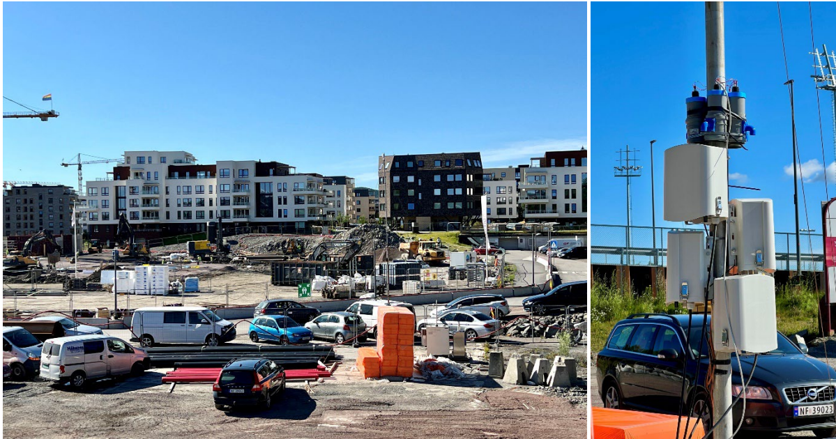
Figur 4: Målestasjon Skårerbyen Nord. (Venstre) Oversikt, meteorologisk mast bak oransjefargede blokker, instrumentskap med svevestøvmonitor og PM 10 -prøvetaker til høyre for mast. (Høyre) Sensorer montert ved meteorologisk mast.
