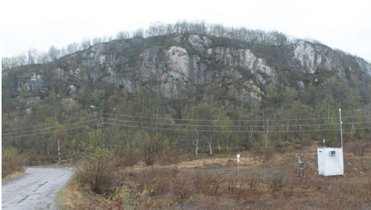
Figur 6: Målestasjonen i Karpdalen sett fra sør-øst. Stasjonen er plassert ute på et myrete jorde, samme sted som i 1986-94. Det er ikke høytvoksende vegetasjon rundt stasjonen. Like vest for stasjonen er det en liten kolle. Måleboden har trakt og svanehals på taket til venstre som er inntak for SO 2 , mast til høyre er meteorologiinstrumenter. Legg også merke til barduneringen, det er værhardt i Karpdalen om vinteren. Til venstre for måleboden står prøvetaker for tungmetaller i luft. Den hvite nedbørsamleren for tungmetaller i nedbør er plassert midt mellom måleboden og veien. Merk også nærhet til vei og strøm, infrastruktur er viktig kriterium for valg av plassering av målestasjon.
