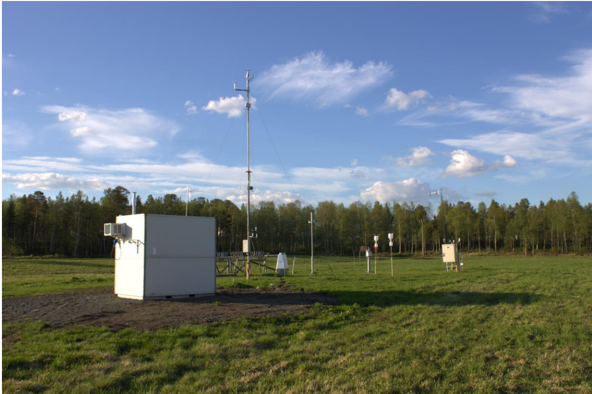
Figur 5: NILUs målestasjon på Svanvik. Den ligger ute på jordet ved Svanhovd miljøsenner (NIBIO). Merk inntak for støvmålinger på taket til venstre og inntak for SO 2 -målinger på taket til høyre (svanehals). Masten har meteorologiinstrumenter i 10 m høyde. To nedbørprøvetakere til høyre tar prøver for tungmetaller. Instrumentet helt til høyre tilhører NVE. Stativet med metallplater i bakgrunnen er en del av et europeisk korrosjonsprosjekt (Grøntoft og Ferm, 2014). Strålevernets instrumenter er skjult bak måleboden.
