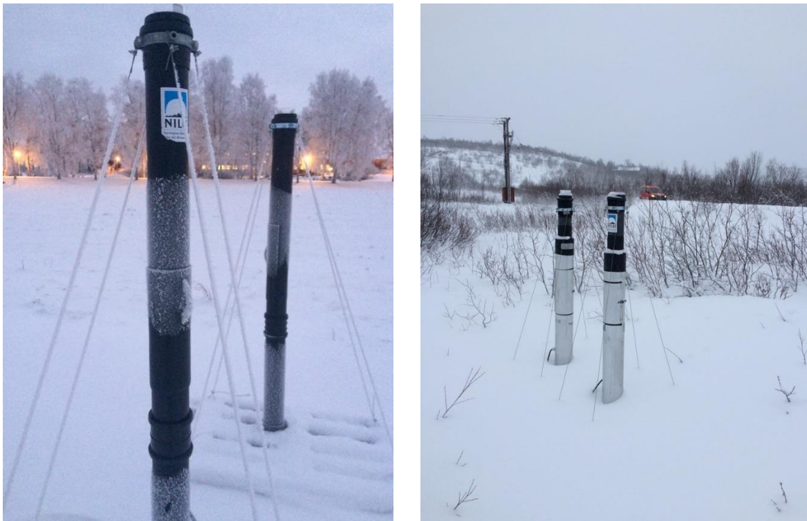
Figur 1: Prøvetakerne for nedbør på Svanvik (venstre) og Karpdalen (høyre). Merk hvordan prøvetakerne på Svanvik lekker varme (svarte partier uten rim). Prøvetakerne i Karpdalen stod tidligere i Ny-Ålesund og var bedre tilpasset arktisk klima.
