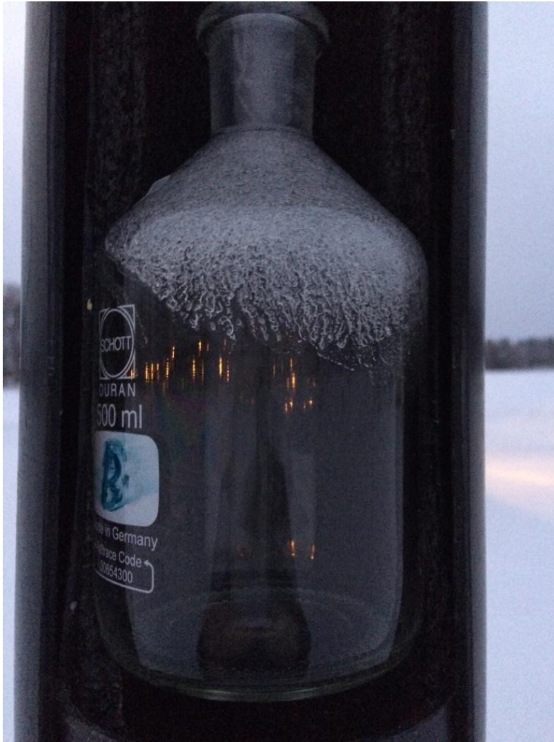
Figur 2: Nedbøren som ble samlet opp på Svanvik frøs til is når det var veldig kaldt (øverst i flasken). Det flytende i bunnen er saltsyre (HCl) som tilsettes flaskene for å stabilisere Hg slik at tap unngås i tiden fra prøvetaking, under transport og til analyse.
