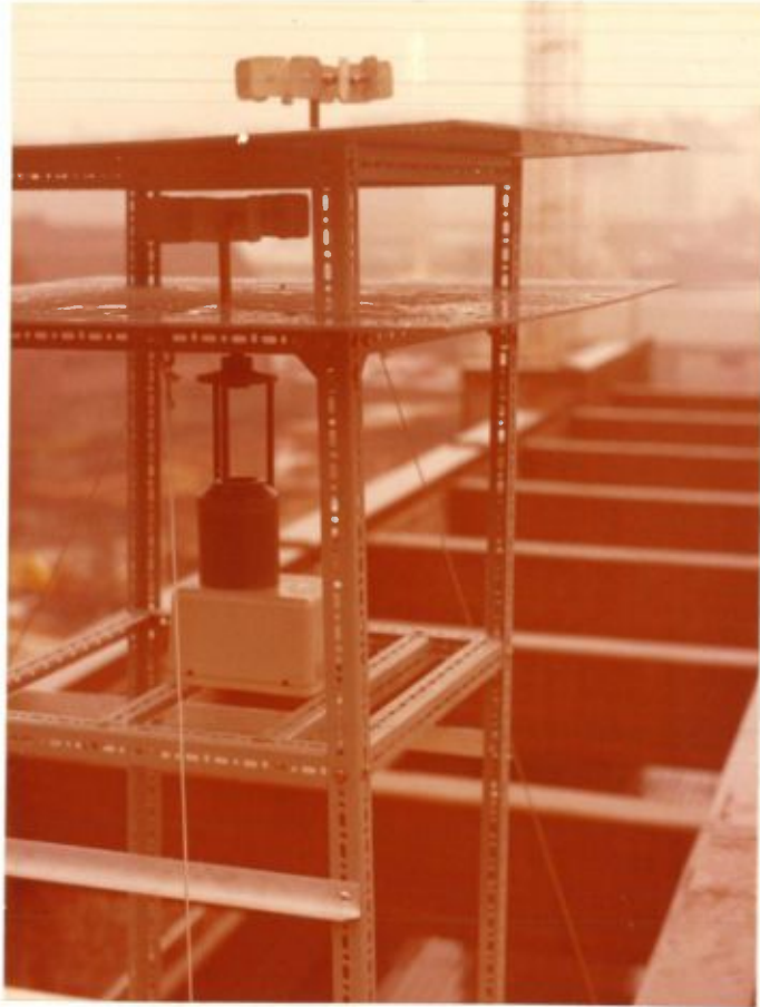
Figur 1: Bilde av forsøksopplegget på taket av Bryggen museem med de tyske steinprøvene og IRMA-apparatet montert.
