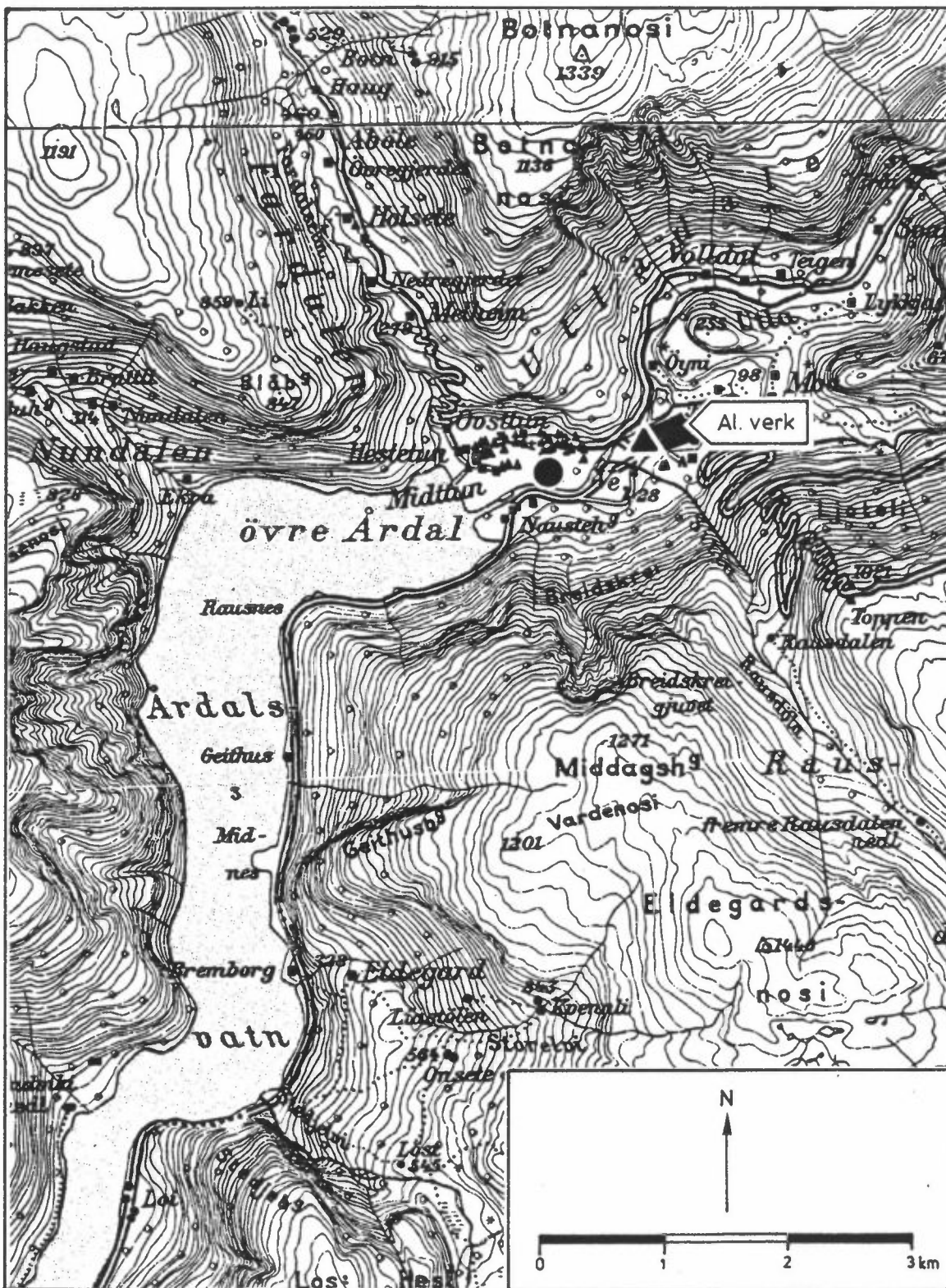
Figur 1: Kart over Øvre Årdal som viser plassering av aluminiumverket, målestasjon ● for luftforurensninger samt vindmøler ▲
