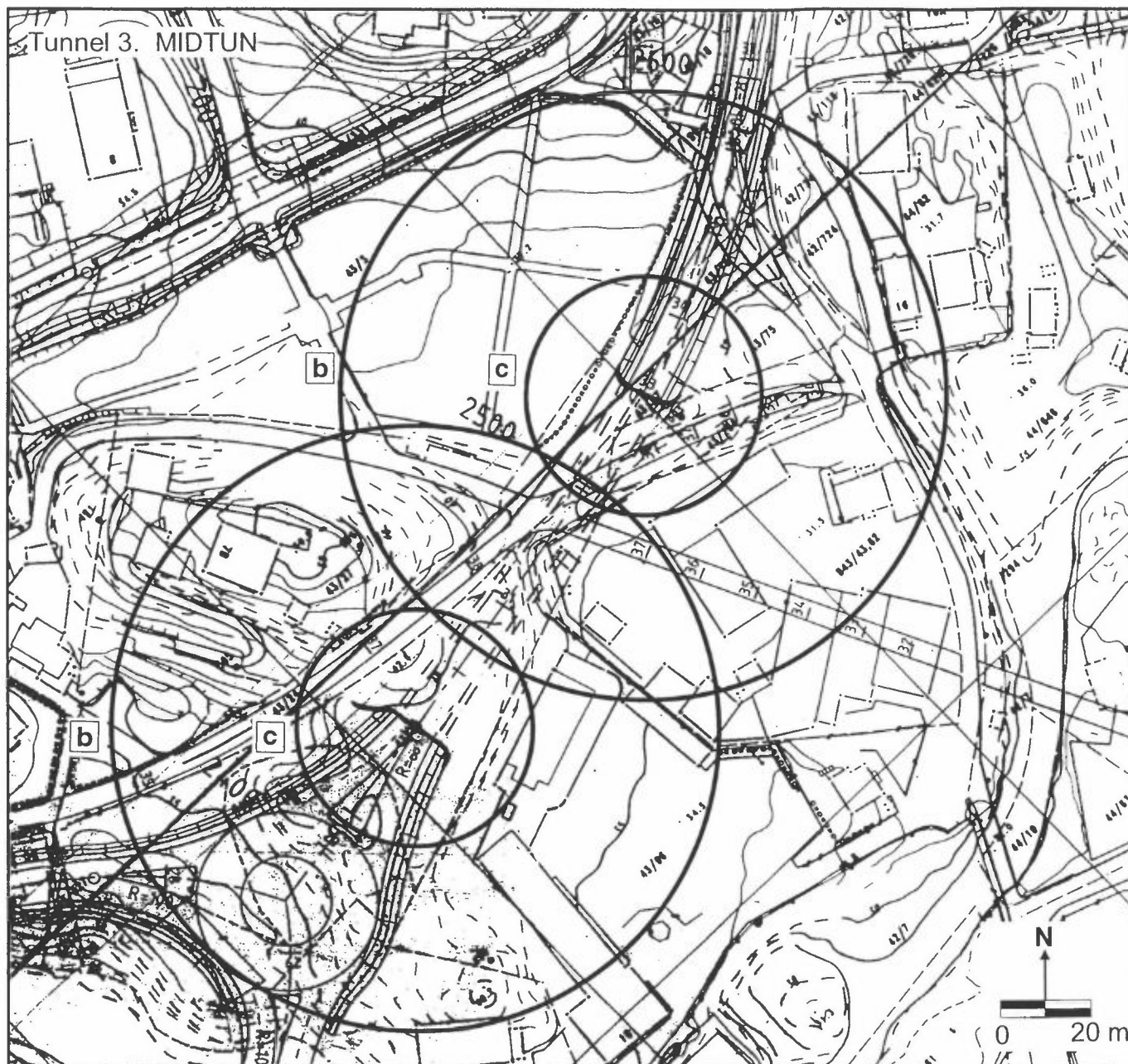
Figur 5: Tunnel 3 (90 m). Figuren viser verst tenkelig tilfelle med kjørehastighet 70 km/h. Sirklene om tunnelmunningene viser ytre grense for overskridelser av a) 25 mg CO/m 3 (kun 1 meters avstand) b) 100 µg NO 2 /m 3 c) 200 µg NO 2 /m 3
