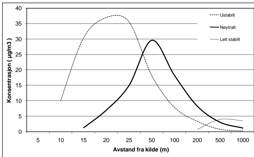
Figur 2a: Alternativ 1: Fyring med flis og olje. Maksimalt NO 2 – bidrag til konsentrasjonen 12 m over bakken (samme høyde som luftinntak på nærliggende bygning).
