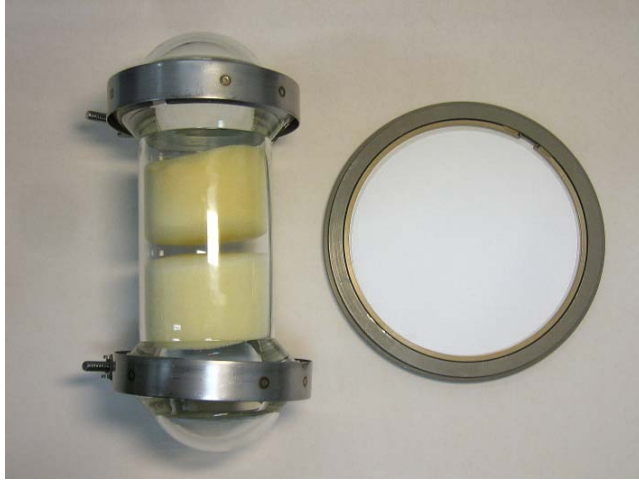
Figur A-4. Komplettest prøveenhet med glassfiberfilter og gassfaseadsorbent.
