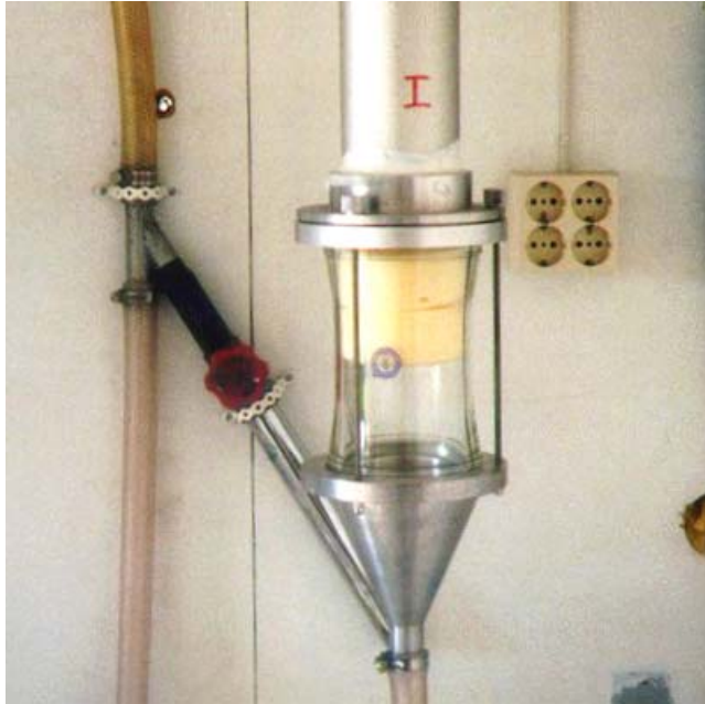
Figur A-6. NILU-PUR-prøvetaker. I den øvre flensen er partikkelfilteret mens PUR-proppene er synlige i glassdelen under.
