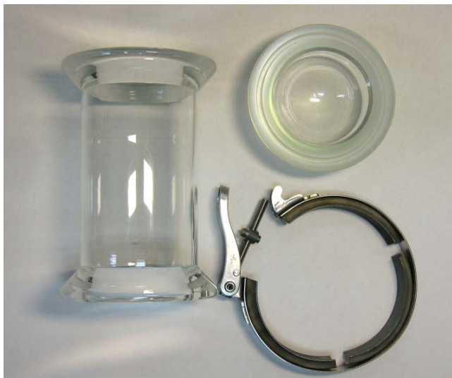
Figur A-2. Glassrør, lokk og klemring til prøvetaker av type Digital DH-77.
