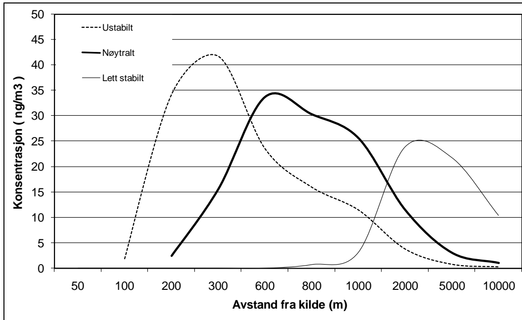
Figur 2: Hg-bidrag til bakkekonsentrasjon. Enhet: \text{ng}/\text{m}^3 ( 10^{-3} \mu\text{g}/\text{m}^3 ). Røykgassmengde 11\,348 \text{ Nm}^3/\text{h} , og avgasshastighet 21,05 \text{ m/s} . 8,89 \text{ g/h} ( 2,469 \text{ mg/s} ).
