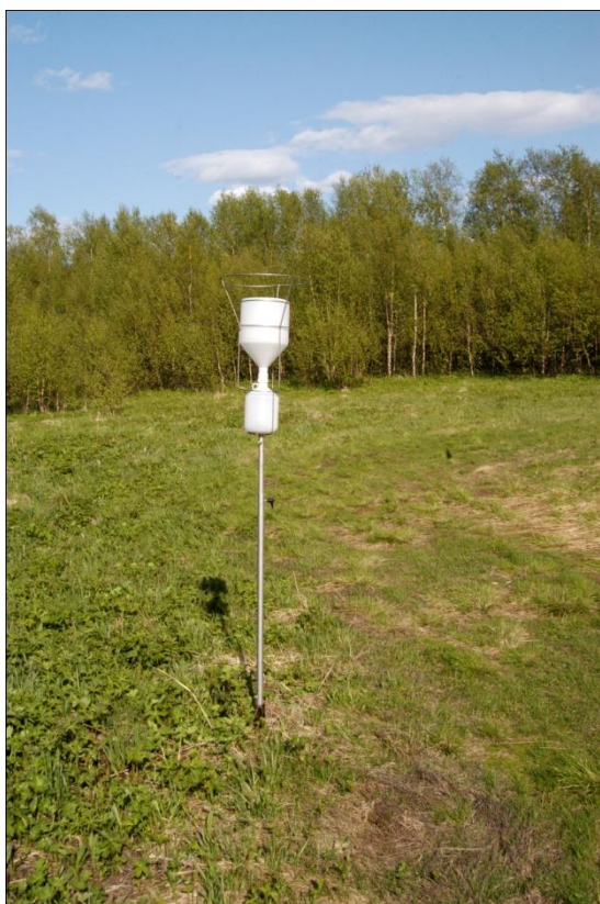
Figur 16: Nedbørsamleren i Karpbukt. Plasttrakt fanger nedbøren som samles i en plastflaske. Legg også merke til ringen øverst. Den er plassert slik for at fugler skal sette seg på ringen framfor kanten av samleren. Dette for å unngå fugleskit i prøven.
