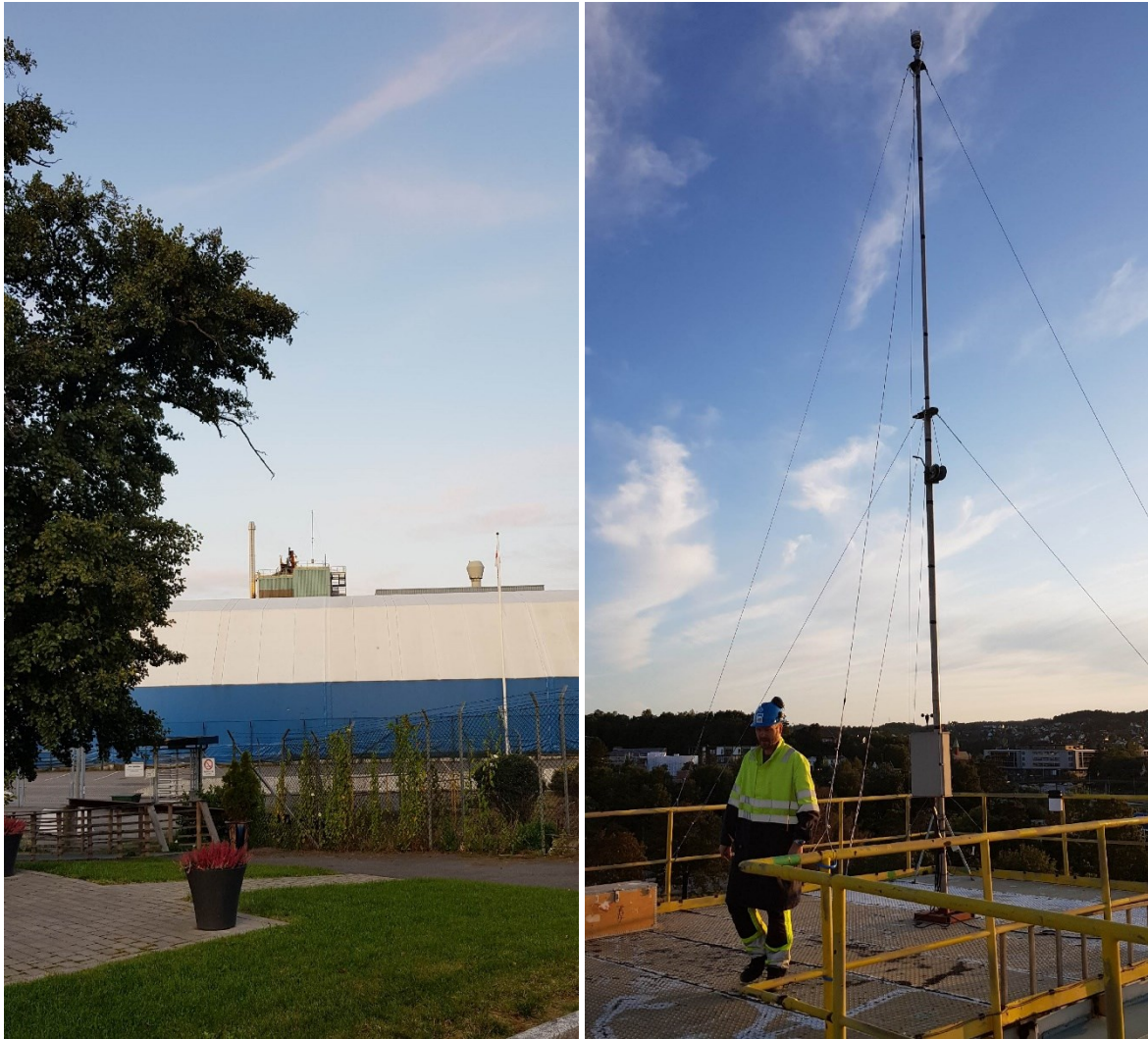
Figur 3: Meteorologisk mast på taket av bygget som huser koksovnene, rett ved faklene fra kalsineringsovnene. Masten er midt i venstre bilde. Foto: Even Kristian Teigland.
