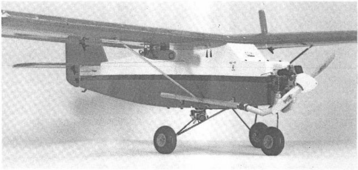
Figur 6: Enkelt fjernstyrt fly, tilpasset for prøvetaking og fotografering.
