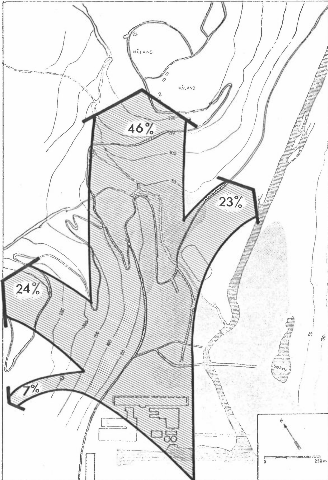
Figur 5.5: Transportretningene ved Håland når vinden over fabrikkområdet blåser fra fjorden. Transport av forurensningene vil dreies i samsvar med pilene som er vist.
