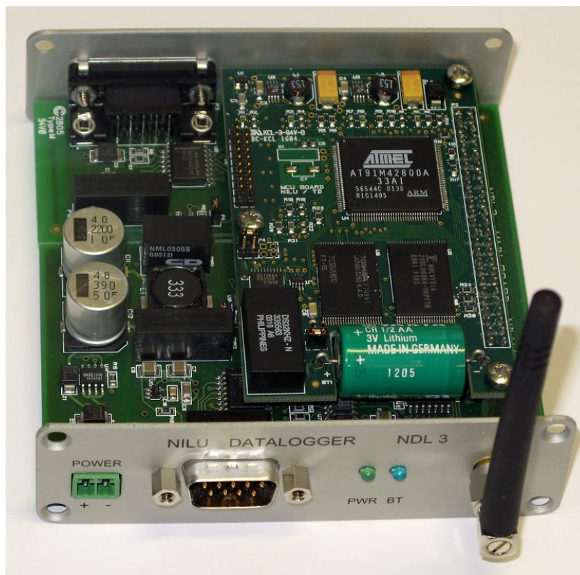
Figur 4. Dataloggeren. Fra venstre ses kontakt for strømforsyning, serieport og antenne for Bluetooth. De to siste for tilkobling av måleinstrument. På bakveggen, til venstre, ses serieport for tilkobling av modem eller PC.
