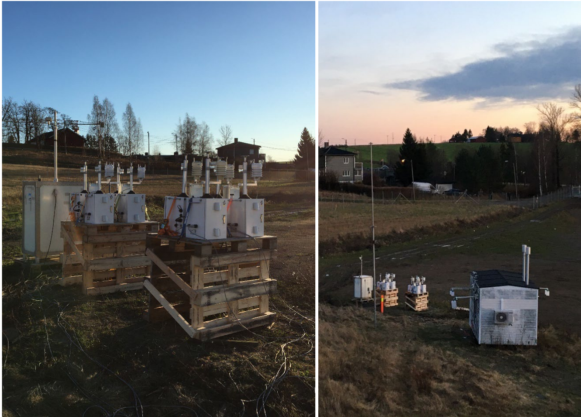
Figur 18: Samlokalisering av støvmåleinstrumentene (TSI-instrumenter, Grimm PM-monitor) og vindsensorer (Vaisala, Gill) på Kjeller høst/vinter 2020. TSI-instrumentene var montert på paller, Vaisala-sensorene var montert på TSI-instrumentene, Gill-sensorene var montert ved veggen og ovenfor taket til måleboden. En Grimm EDM 180 svevestøvmonitor var plassert i måleskap ved siden av TSI-instrumentene. Foto: Anne Cathrine Nilsen
