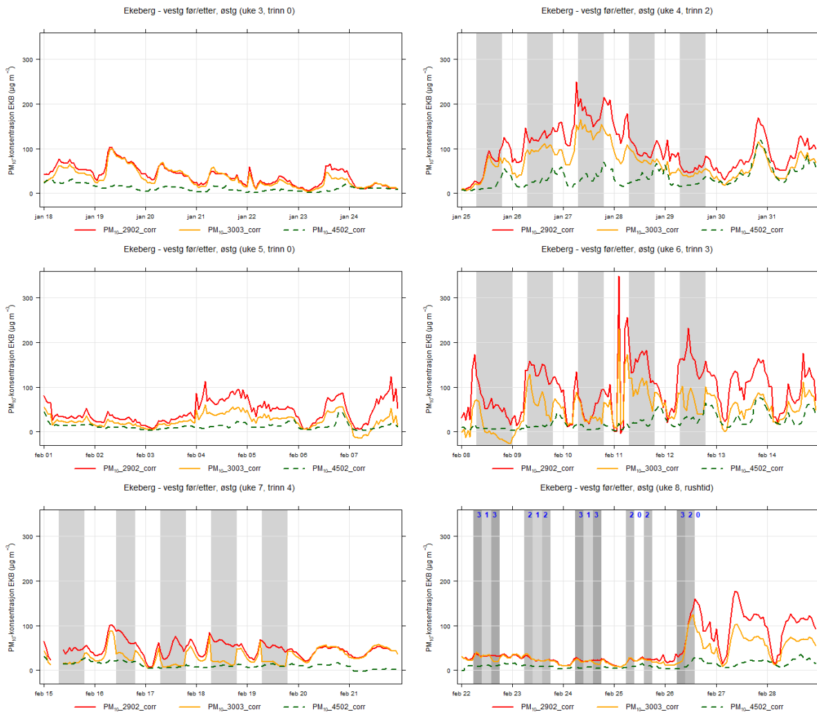
Figur 42: PM_{10} -konsentrasjon i Ekeberg-tunnelen i måleperioden, per uke. Rød: Vestgående løp før ventilasjonstårnet (2902). Gul: Vestgående løp etter ventilasjonstårnet (3003). Grønn: Østgående løp (4502). Grå bakgrunn viser når ventilasjonstårnene var i drift. For uke 8 er ventilasjonstrinn vist med blå tall.
