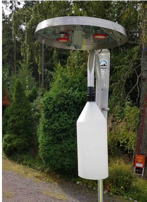
Figur 5: Passive prøvetakere i stativ som gir værbeskyttelse. Her vises prøvetakeren som er samlokalisert med målestasjonen i Konsul Wilds vei. Bildet viser 2 parallelle prøvetakere, som brukt i 2019. I 2022 var det én prøvetaker per målepunkt. Merk at den er montert rett ovenfor inntaket til SO 2 -monitoren. Foto: Even Kristian Teigland.
