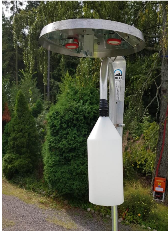
Figur 5: Passive prøvetakere i stativ som gir værbeskyttelse. Her vises prøvetakeren som er samlokalisert med målestasjonen i Konsul Wilds vei. Bildet viser 2 parallelle prøvetakere, som ble brukt i 2019. I 2023 var det én prøvetaker per målepunkt. Merk at den er montert rett ovenfor inntaket til SO 2 -monitoren. Foto: Even Kristian Teigland.
